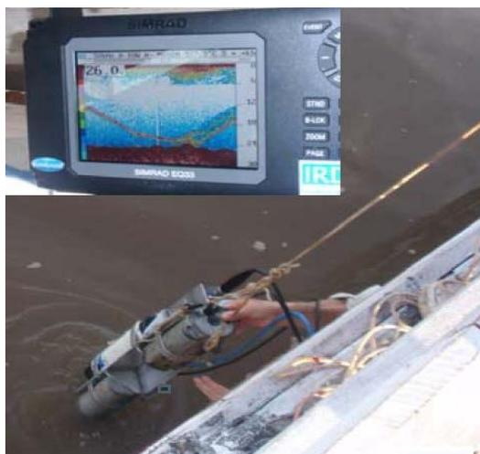
Figura 1.22. Sonda de Turbidez YSI-6V
