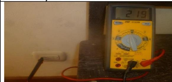
Medición de voltaje de corriente alterna
