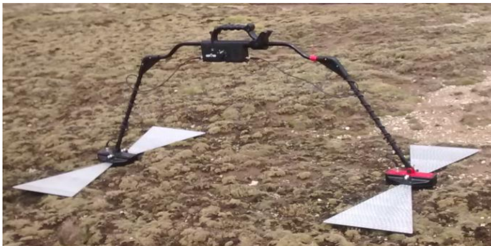
Figura 3.22. Georadar Gepard armado con antena triangular
