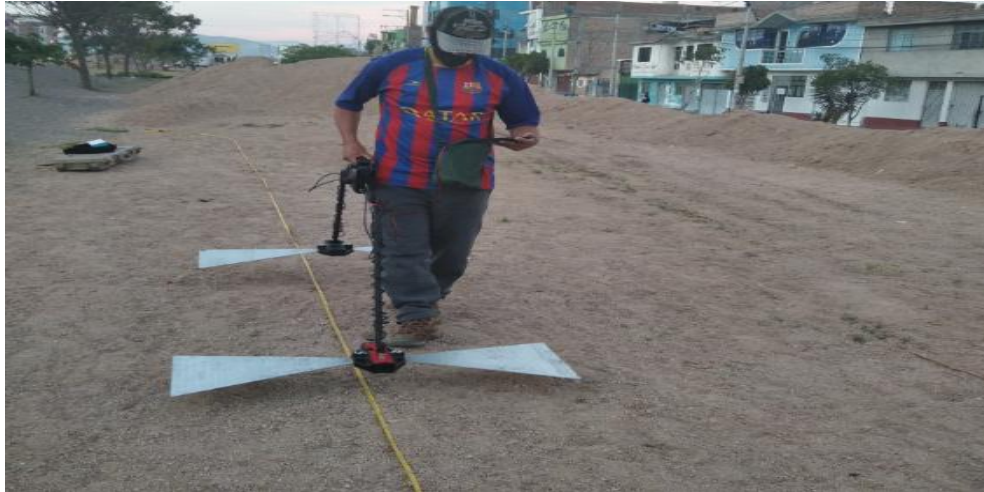
Figura 3.21. Prospección del subsuelo con georadar Gepard
