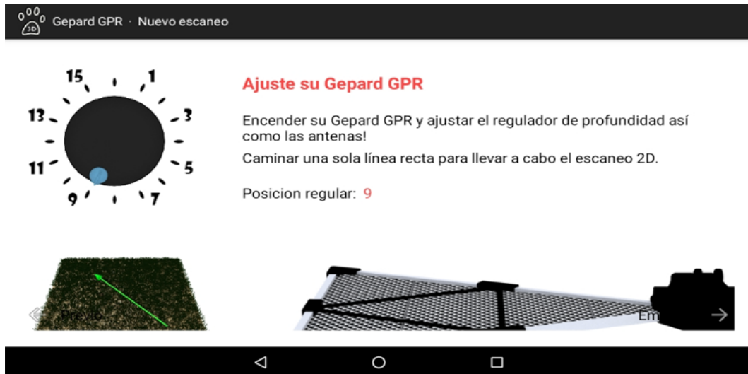
Figura 3.19. Ventana de configuración, regulador de profundidad
