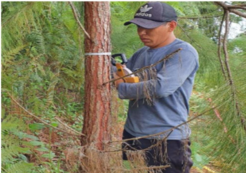
**Figura 2.4.** Diámetro del pino a la altura del pecho, utilizando cinta métrica
