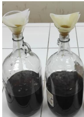
Filtración de la muestra
