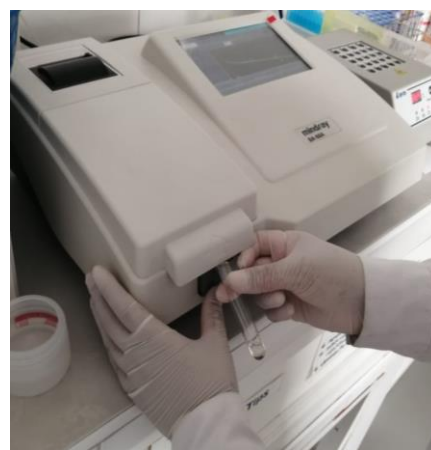
Fotografía N°5: lectura a 366nm en el equipo UV
