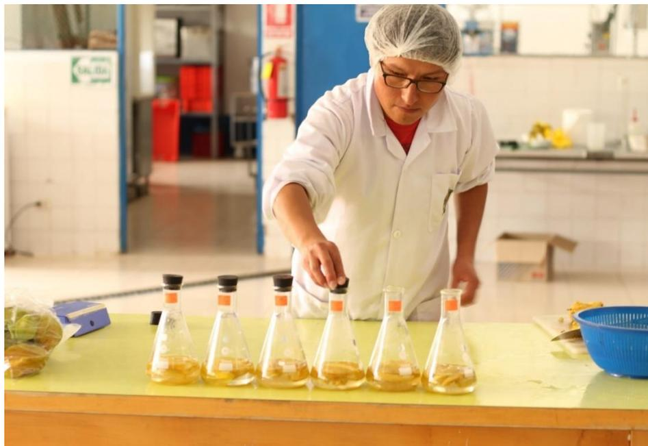
**FOTO N° 07: CONTROL DE PERDIDA DE PESO EN ENSAYOS PREELIMINARES DE OSMODESHIDRATACIÓN CON 6 TRATAMIENTOS Y CORTE LONGITUDINAL**
