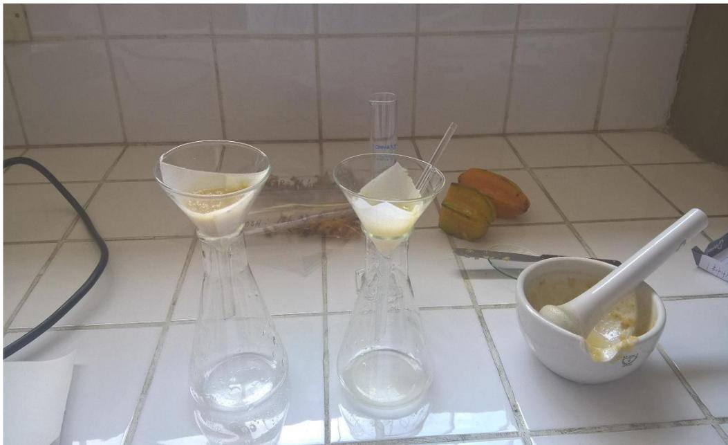
**FOTO N° 25: FILTRACIÓN DE MUESTRAS (MATERIA PRIMA Y OSMODESHIDRATADOS) PARA DETERMINACIÓN DE CONTENIDO DE ÁCIDO ASCÓRBICO**
