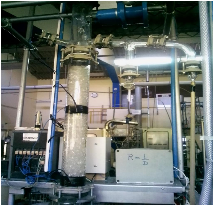
Sistema de reflujo y sensor de temperatura T_4
