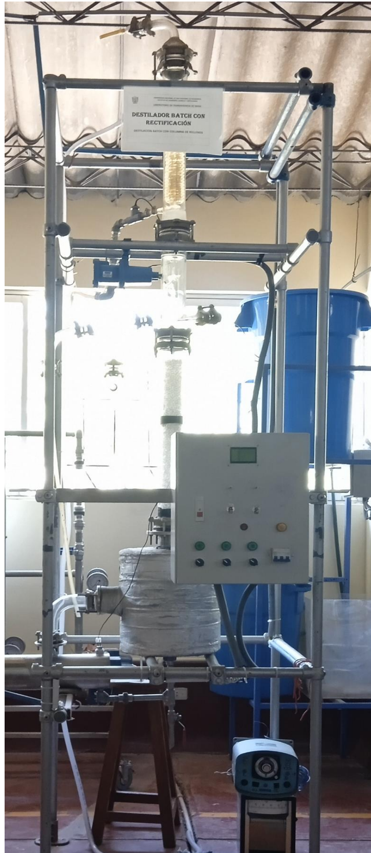
Equipo de destilación batch con rectificación, vista frontal
