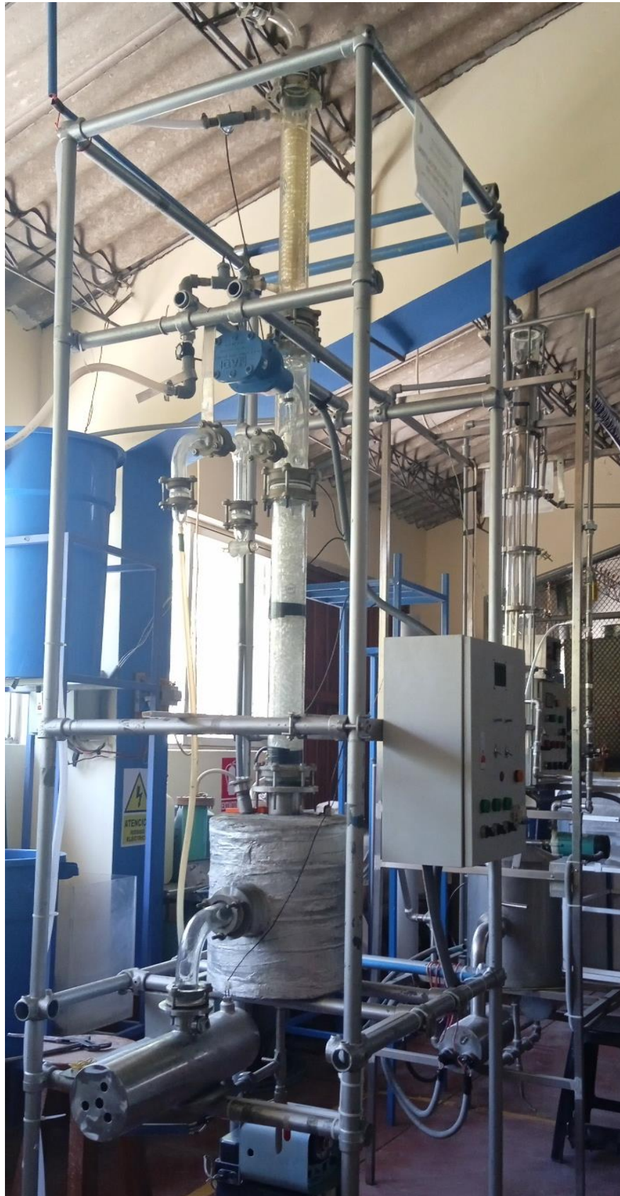
Equipo de destilación batch con rectificación, vista lateral
