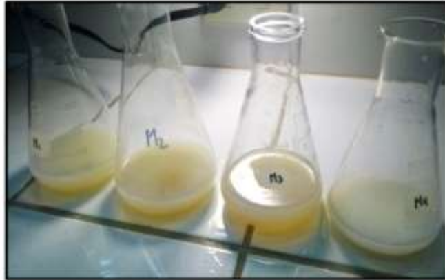
Prueba cualitativa de fosfatos en muestras de concreto
