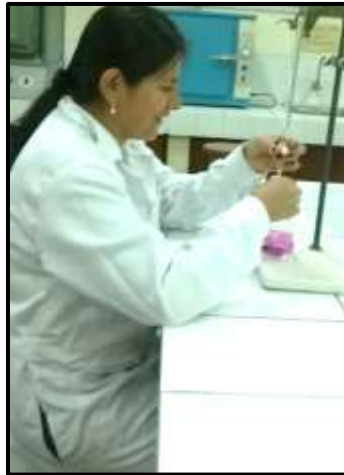
Determinación de cloruros en muestras de suelo y concreto
