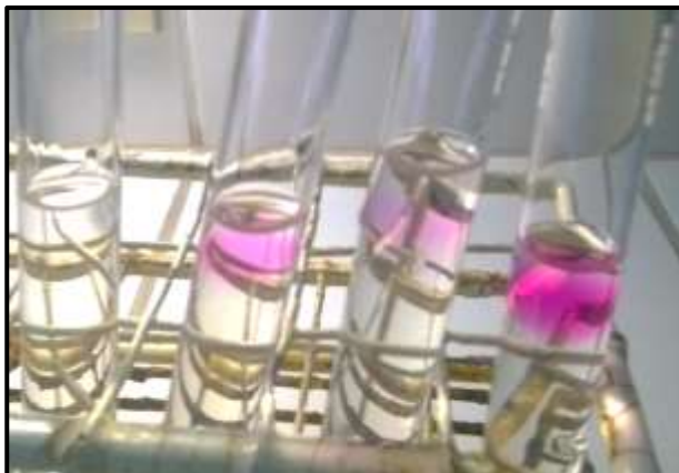
Prueba de la fenolftaleína; la coloración indica presencia de álcalis y el grado de carbonatación: 1, 2, 3 y 4.
