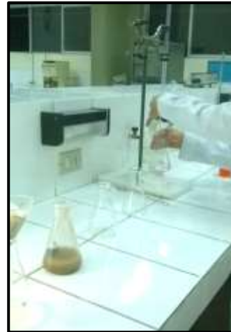
Determinación de cloruros en muestras de suelo y concreto
