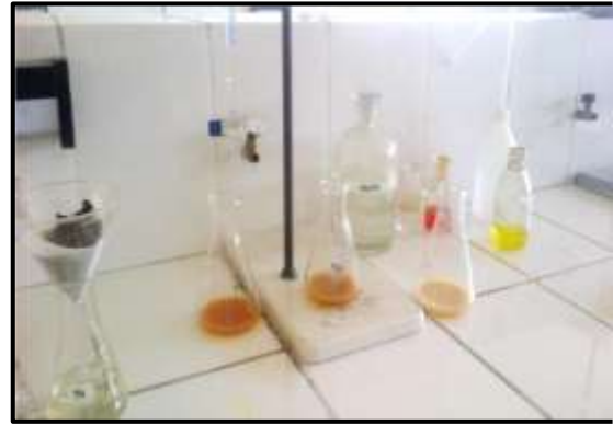
Determinación de cloruros en muestras de suelo y concreto
