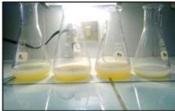
Prueba cualitativa de cloruros en el concreto.
