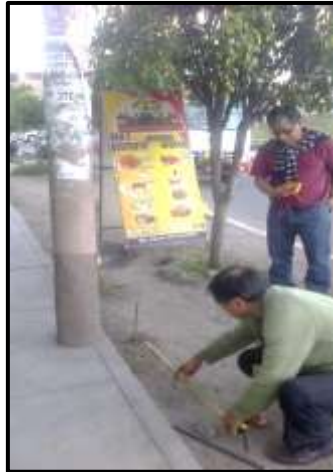
Medición de la resistencia de terreno.
