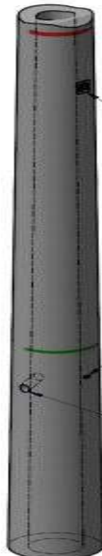
Figura 2.3: Postes de concreto armado fuente arriba (CETUNE, 2015).
