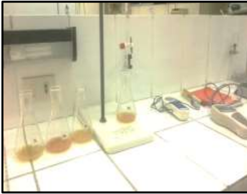
Determinación de cloruros en muestras de suelo y concreto
