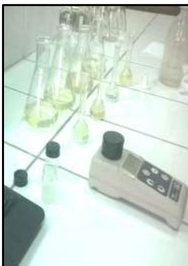
Determinación de sulfatos en muestras de suelo y concreto.
