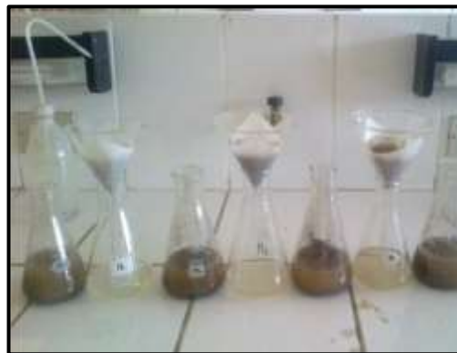
Filtrado del extracto acuoso de las muestras de concreto
