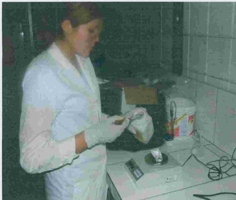
Fotografía nº11: Disolución del catalizador: es la mezcla del (metanol) con el catalizador (hidróxido de sodio o potasio).
