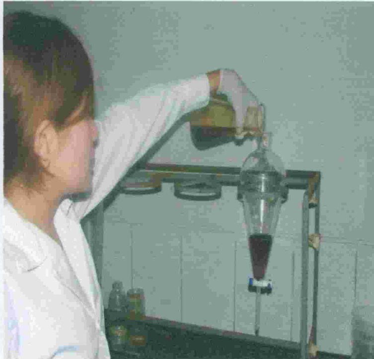
Fotografía n°15: Decantación etapa en que se separa el biodiésel de la glicerina.
