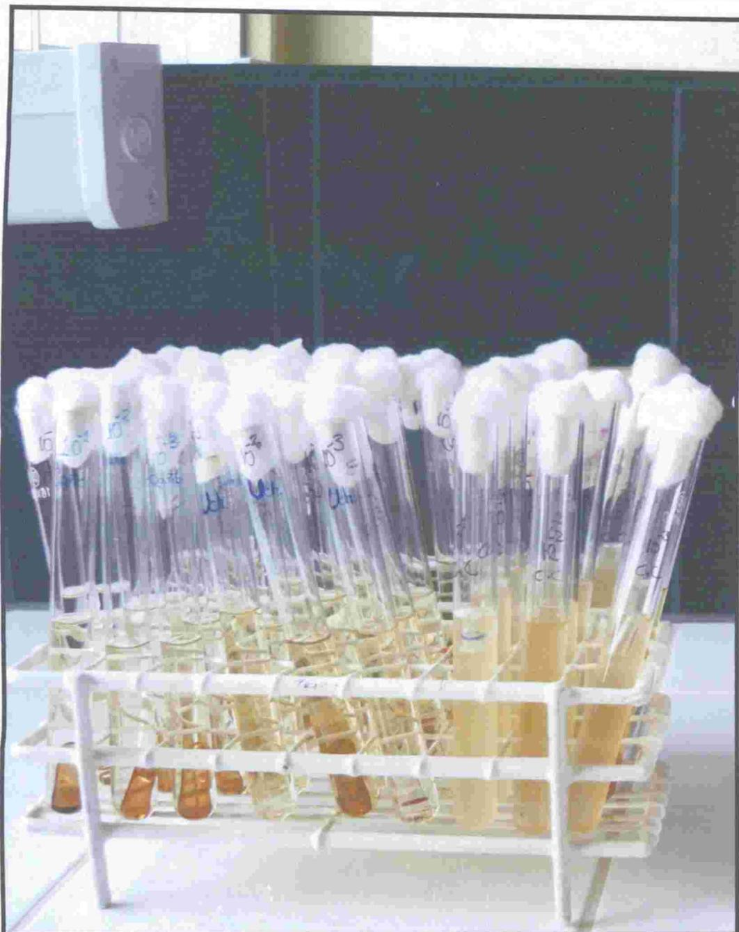
**Fotografía N° 04:** Prueba confirmativa de coliformes fecales (termotolerantes) en medio *E. coli* con presencia de gas reportadas en NMP/100 mL en muestra de agua del canal lateral abierto río Cachi en la comunidad de Uchuypampa, 2010.
