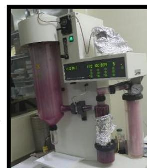
Dependiendo de la muestra y el método la T° se puede manipular a 120°C.
