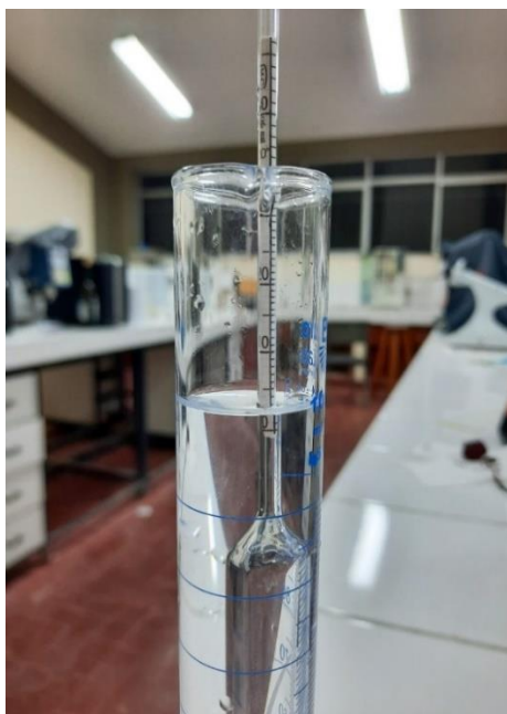
Figura 12. Lectura de grados alcohólicos de la muestra destilada
