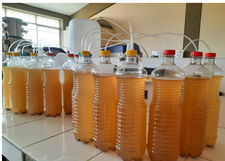
Figura 9. Fermentación alcohólica de los extractos azucarados
