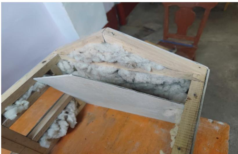
Figura 3.8: Acondicionamiento con aislante térmico lana de oveja en el aula prototipo a escala
