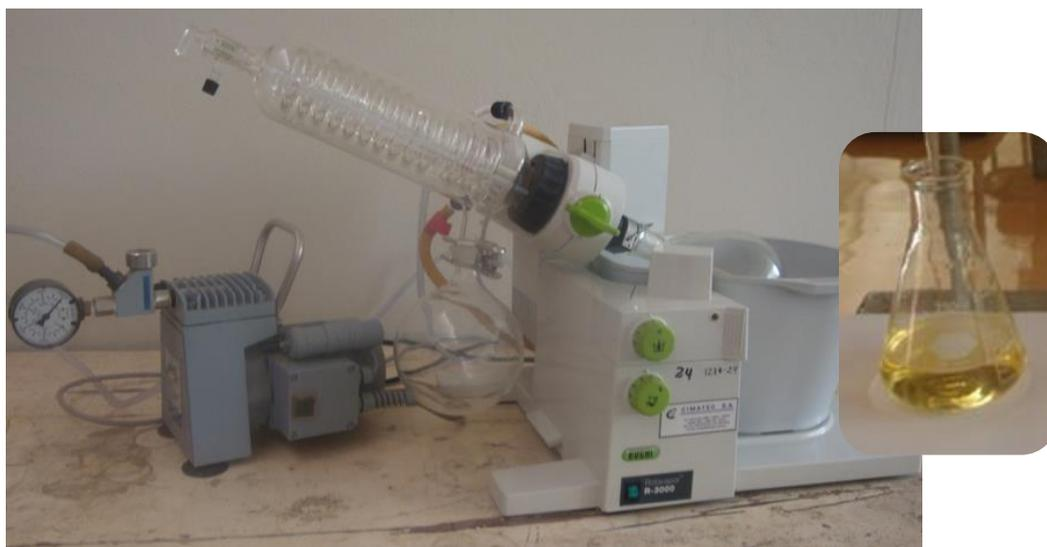
El solvente empleado en la extracción se recupera en el rotavapor, dado que destila por tener menor punto de ebullición con respecto al aceite; mientras que, en el balón queda el aceite crudo o no refinado. Una vez enfriado el
