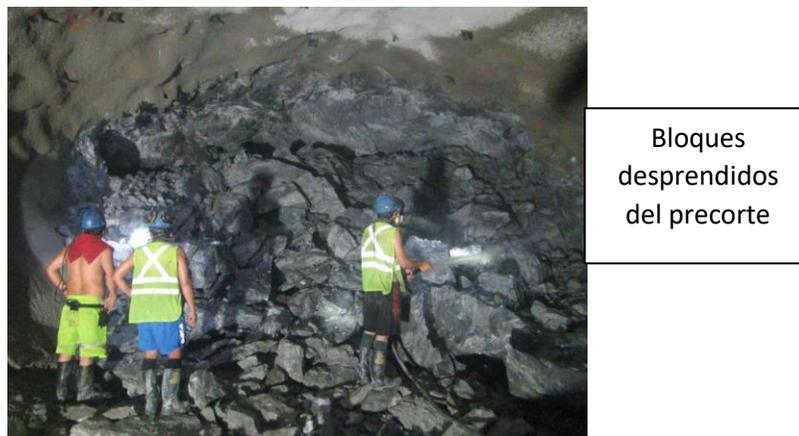
En la figura 25 se observa el resultado de la voladura precorte, sobre la pila de mineral se observa bloques desprendidos del precorte, bloques con medidas de 0.6x0.4x2.0m (ancho, alto, largo), estos bloques son generados por el plano de fractura, y los taladros de amortiguación son los encargados de desprender por completo.
