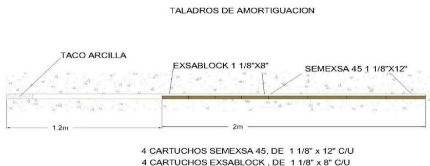
La densidad de carga lineal considerando el reparto de energía por todo el taladro será de 0.44Kg/m. en modelamiento de vibraciones por Holmberg y Persson se verificará si procede.
