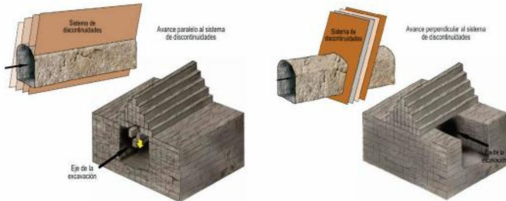
Condiciones de avance muy desfavorable para la estabilidad. La estructura rocosa funciona a manera de varillas apiladas en forma paralela a la excavación, las mismas que presentan inestabilidad.
