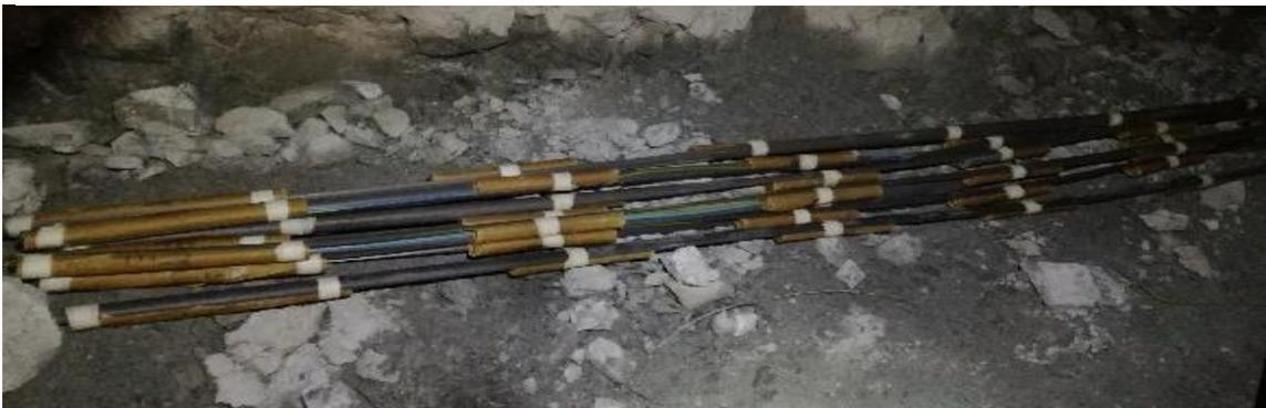
La carga desacoplada consta de 5 cartuchos de exablock unidas mediante exsacord y están espaciadas a 37 cm
