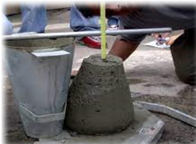
Figura 14: Ensayo de la trabajabilidad del concreto fresco
