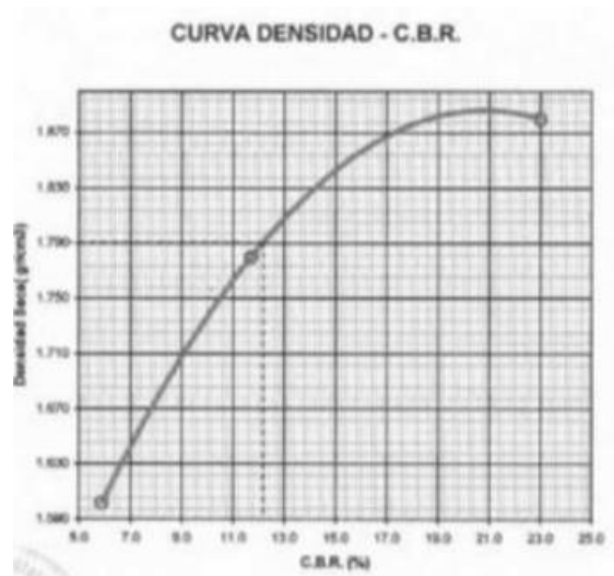
Figura 27: Curva densidad CRB realizada en la Avenida Javier perez de Cueññar cuadra 2
