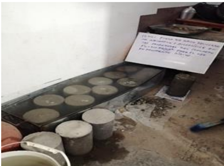
Figura 20: Curado estándar de probetas cilíndricas y vigas
