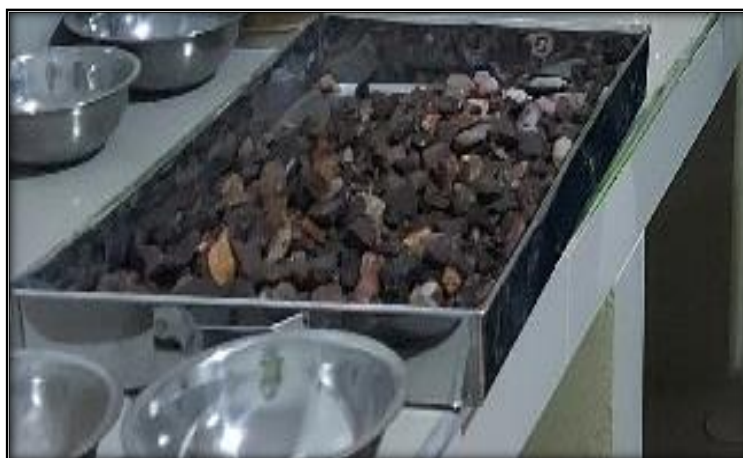
Figura 19: Ensayo de análisis granulométrico del agregado grueso.
