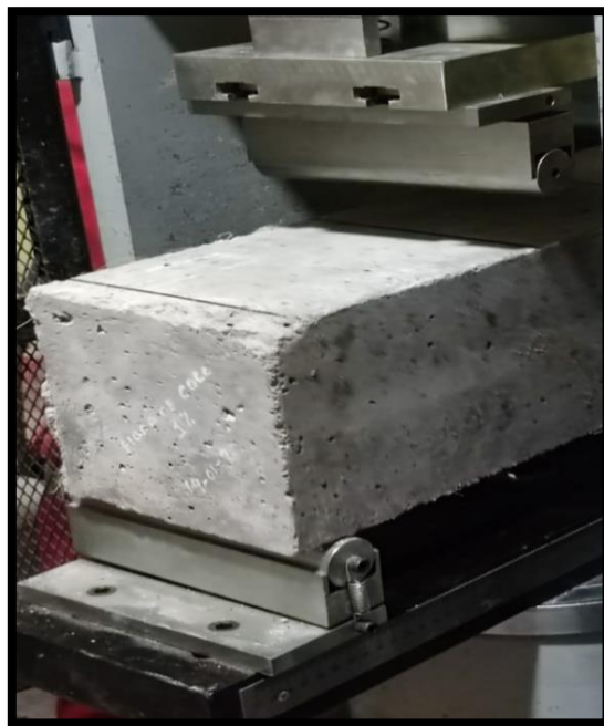
Figura 10: Ensayo de resistencia a la flexión del concreto
