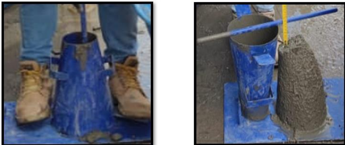
Figura 7: Ensayo de slump.
