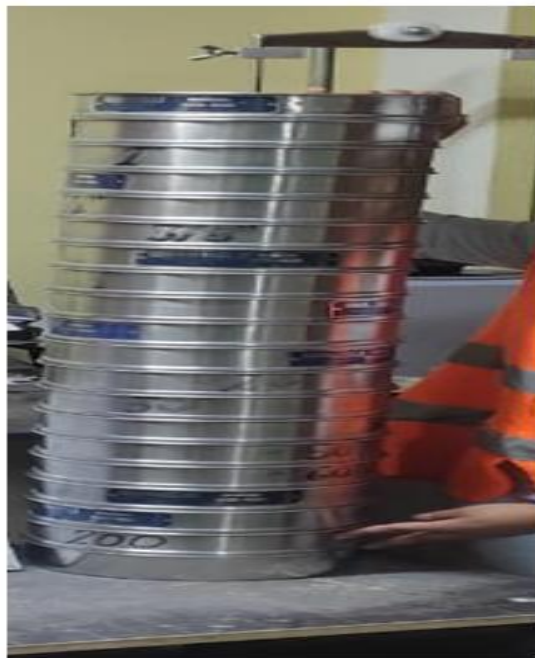
Figura 15: Tamizador para ensayo de granulometría de los agregados
