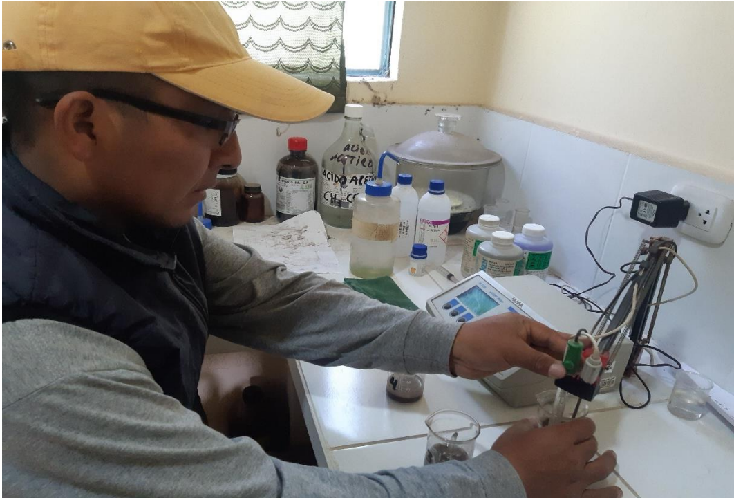
Foto 21. Determinación del pH del suelo
