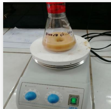
Extracción con 100 mL de metanol en agitador por 4 h.
