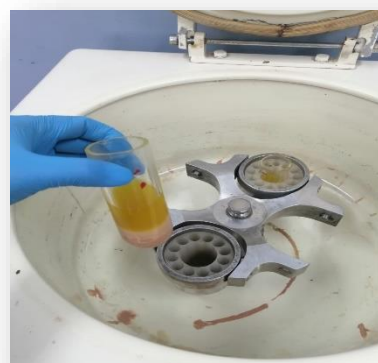
Centrifugar a 2500 RPM x 10 min, repetir 1 vez el proceso.
