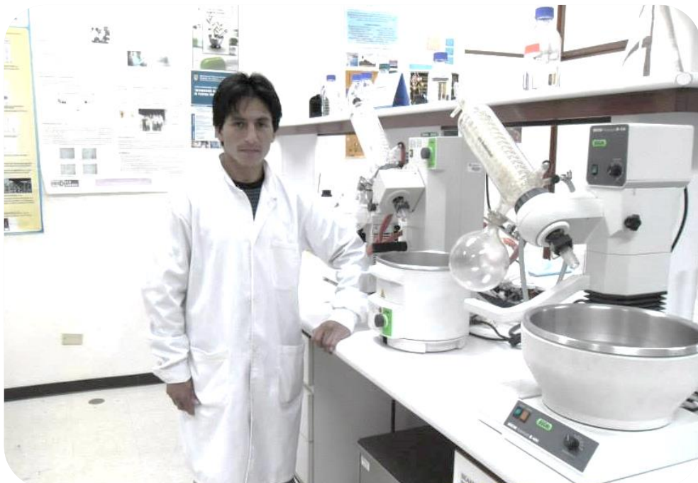
Foto 12. Equipos utilizados en el laboratorio de la Universidad Peruana Cayetano Heredia, para determinar el contenido de saponinas y betalainas por el método HPLC
