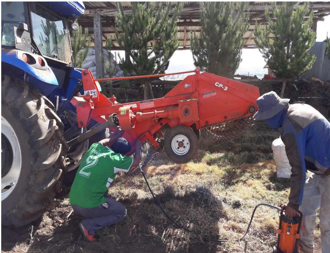
Fotografía 02. Verificación, calibración para inicio de la cosecha con cadena.
