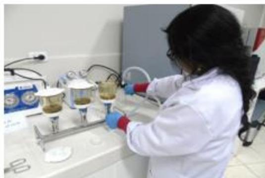
**Fotografía 7.** Filtración al vacío
