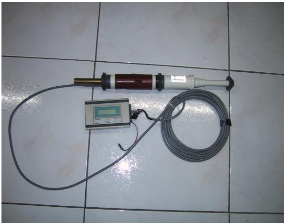
FOTO N° 1: Instrumento para medir insitu la variación de esfuerzos
