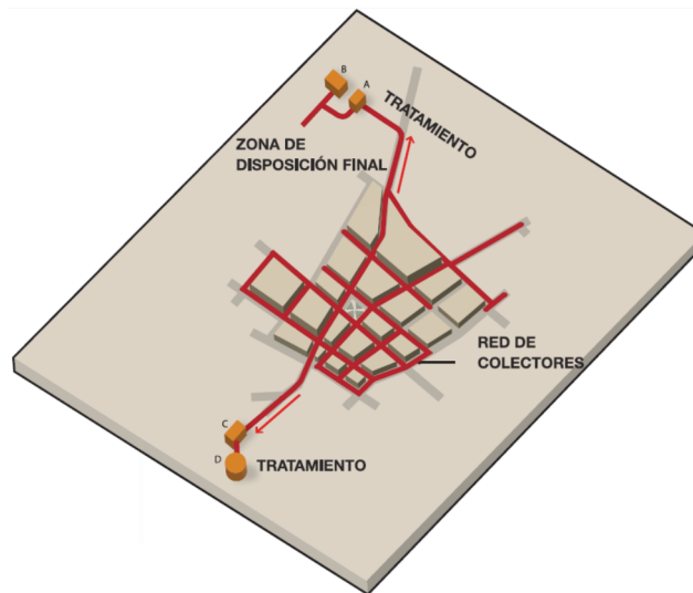
Figura 2.5: Red de alcantarillado convencional
