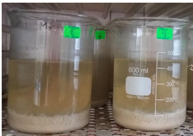
Figura 3.7: suspensión en el jarabe bruto obtenido y el sedimento es el almidón no hidrolizado
