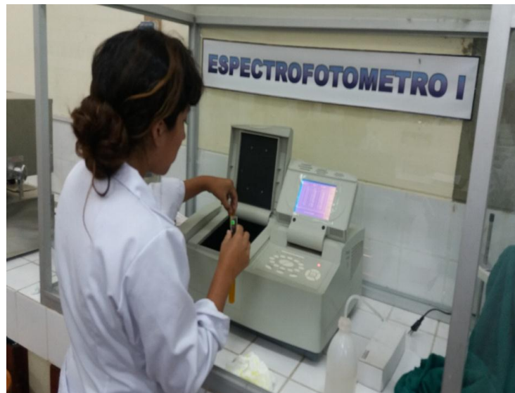
Figura 3.12: Medición de estabilidad de color
