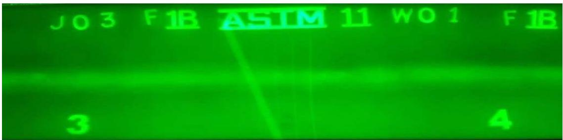
Figura 26. Interpretación radiográfica API 1104. Inclusión de material extraño en la zona de interés. [Ingecontrol SAC: Proy. Red de Gas Contugas Ica 2013]
