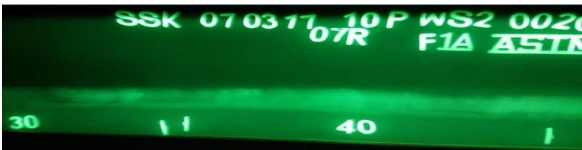
Figura 28. Interpretación radiográfica API 1104: (a) Falta de fusión (IF) y (b) escoria lineal (ESI). Ambas indicaciones superan los límites de aceptación: Reparar soldadura. [Inspection Technologies SAC: Proy. Parada en Refinería Talara 2018]
