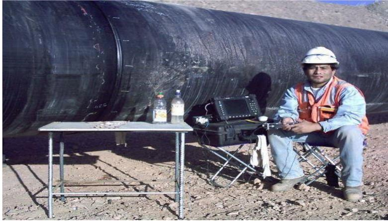
**Figura 24. Inspección por ultrasonido técnica TOFD [INGECONTROL SAC Proyecto Cerro Verde 2007]**
