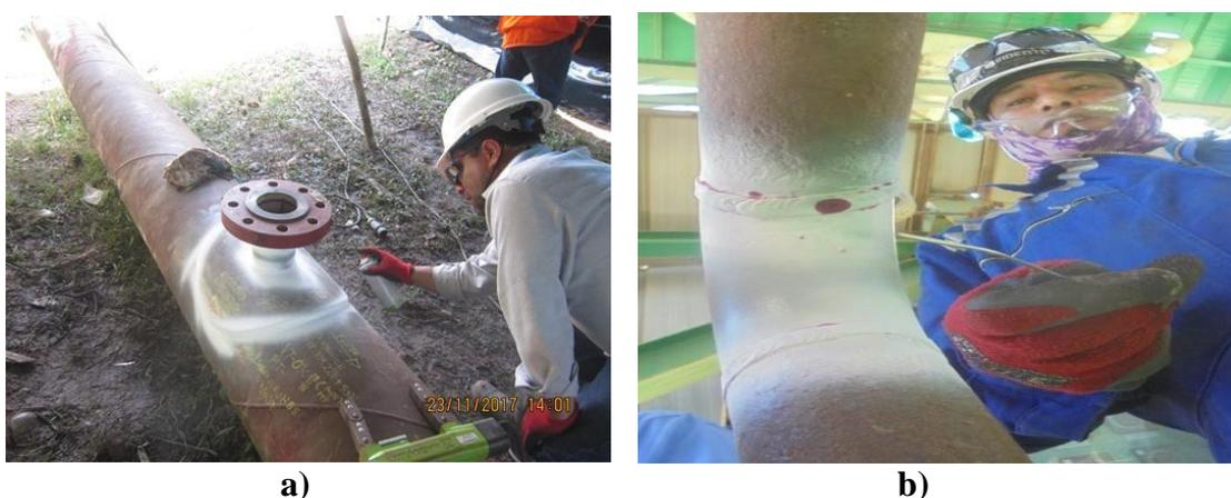
**Figura 16. Aplicación de líquidos penetrantes (a) Accesorio de Ø 3” [Oleoducto RamalNor Peruano 2017] (b) Indicación a reparar tubería de Ø2” [Parada de mantenimiento Refinería Talara, 2018]**
