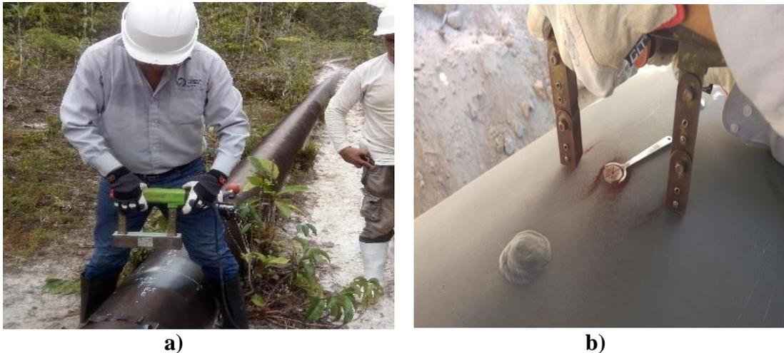
**Figura 18. Prueba de magnetización (a) prueba de poder o levante, y (b) dirección de campo magnético [Proyecto Oleoducto Nor y Ramal Peruano: 2017]**
