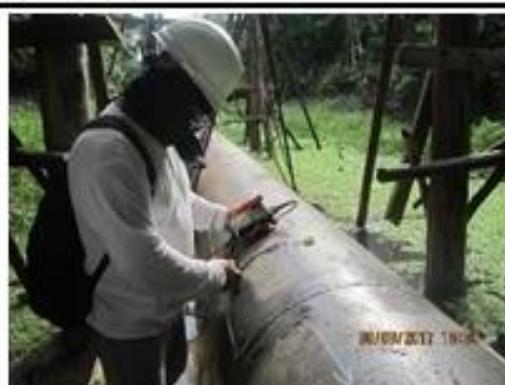
FOTO 23: Medición del espesor de las RMB's existentes y de la tubería.
