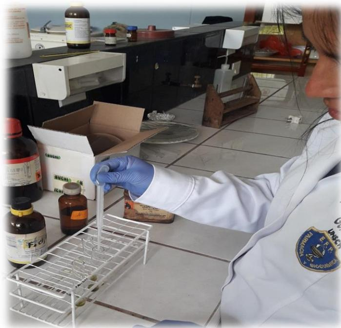
Adicionando los reactivos respectivos para la identificación de fenoles (cloruro ferrico 5%) y flavonoides (magnesio metálico + HCl concentrado)
