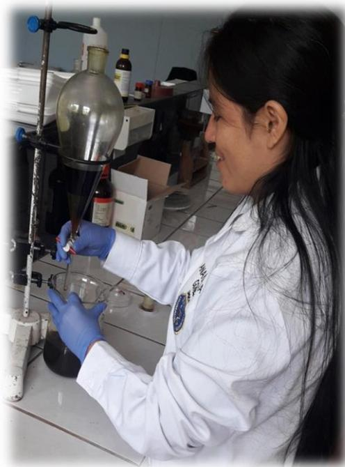
Separación de la fracción de acetato de etilo
