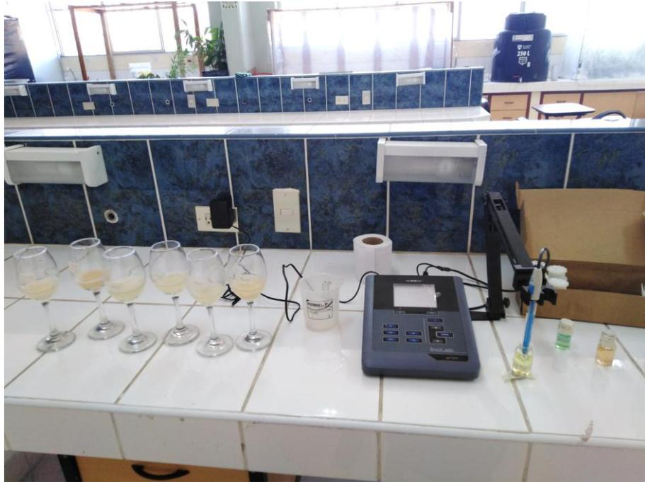
Foto 24. Calibración de medidor de pH de sobremesa
