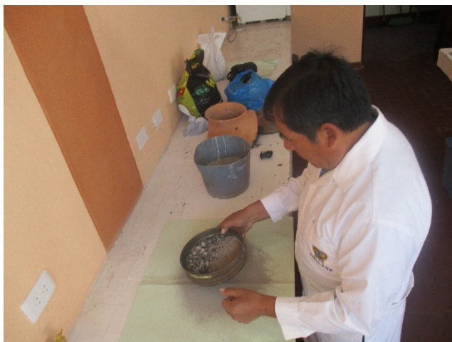
Foto 3: Tamizado de las cenizas de eucalipto
