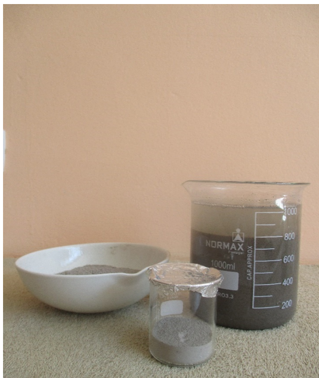
Foto 4: Lavado de las cenizas de eucalipto
