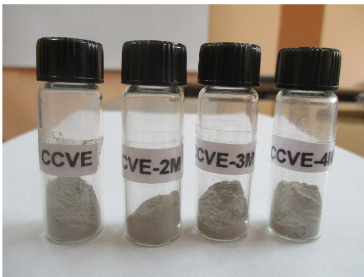
Foto 7: muestras de cenizas para DRX y análisis método BET
