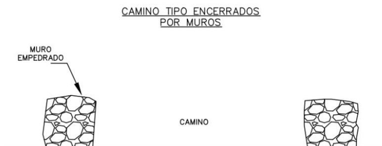
Fig. 84: Dibujo del tipo de camino encerrados por muros en los laterales o bordes de las calzadas.
