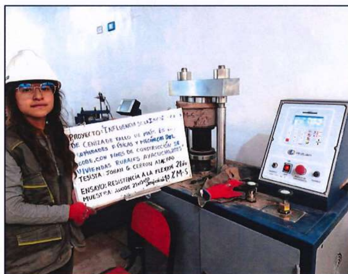
Figura 81: Lectura de la muestra M-5 con 10% de ceniza de tallo de maíz
