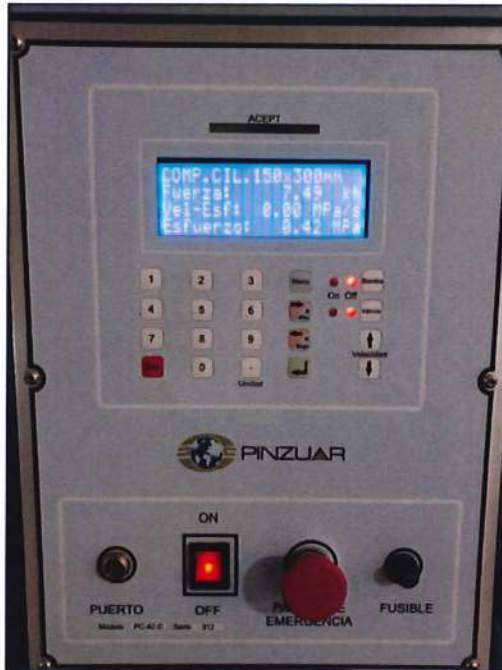
Figura 17: Lectura de la muestra M-1 con 0% de ceniza de tallo de maíz
