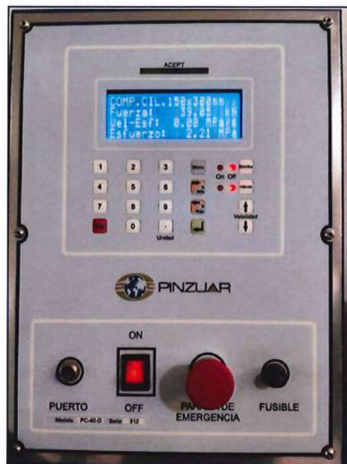
Figura 69: Lectura de la muestra M-4 con 5% de ceniza de tallo de maíz
