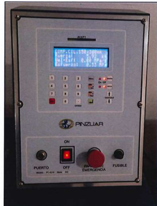
Figura 18: Lectura de la muestra M-2 con 0% de ceniza de tallo de maíz
