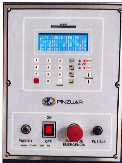
Figura 58: Lectura de la muestra M-4 con 5% de ceniza de tallo de maíz
