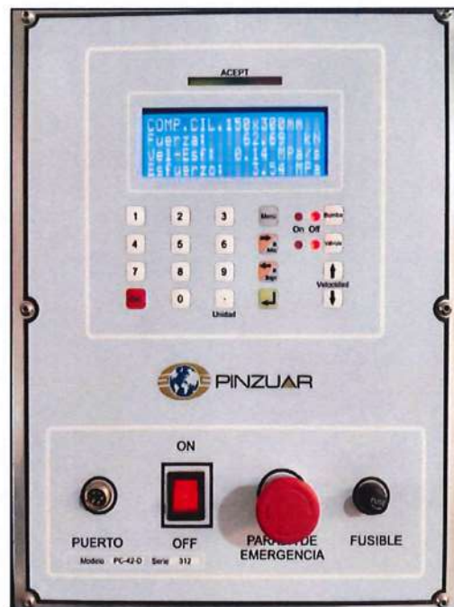
Figura 73: Lectura de la muestra M-5 con 7.5% de ceniza de tallo de maíz
