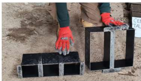
Figura 27 Moldes para la elaboración de los adobes.
