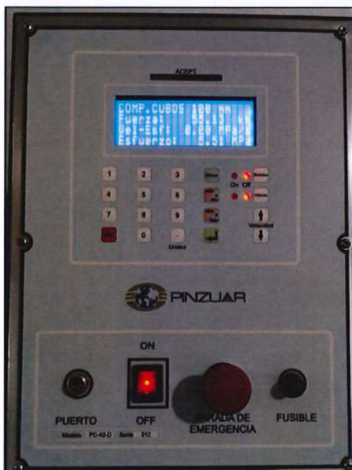
Figura 70: Lectura de la muestra M-1 con 7.5% de ceniza de tallo de maíz
