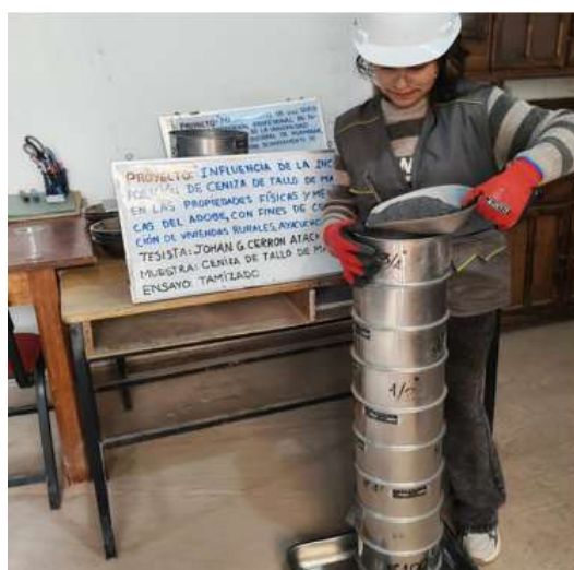
Figura 8 Tamizado de ceniza de tallo de maíz.
