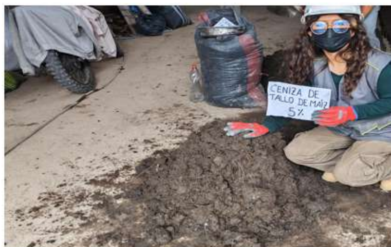
Figura 31 Dormido de la mezcla para la elaboración de adobes.
