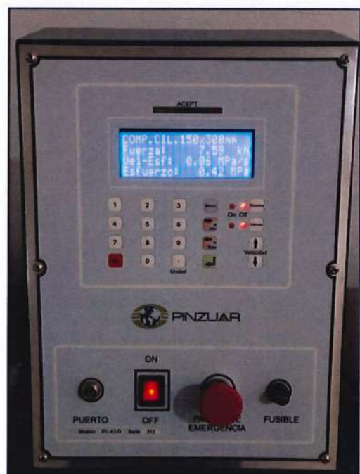
Figura 20: Lectura de la muestra M-6 con 0% de ceniza de tallo de maíz
