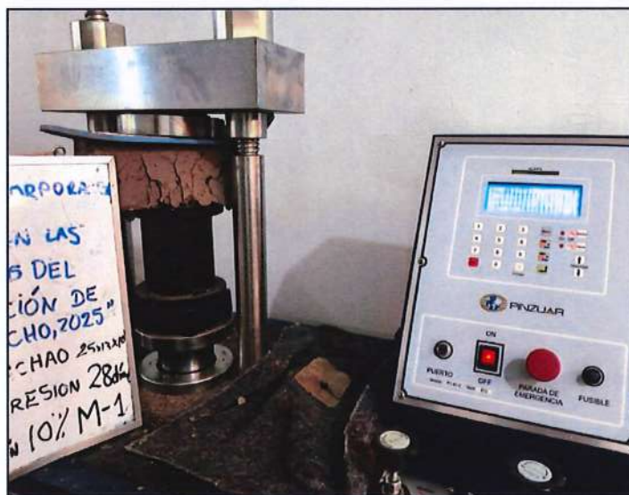
Figura 74: Lectura de la muestra M-1 con 10% de ceniza de tallo de maíz
