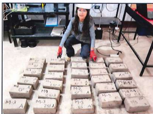
Figura 11: Muestras con 0%, 2.5%, 5%, 7.5% y 10% de ceniza de tallo de maíz.
