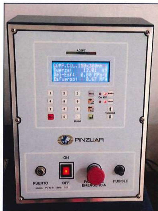
Figura 30: Lectura de la muestra M-5 con 7.5% de ceniza de tallo de maíz
