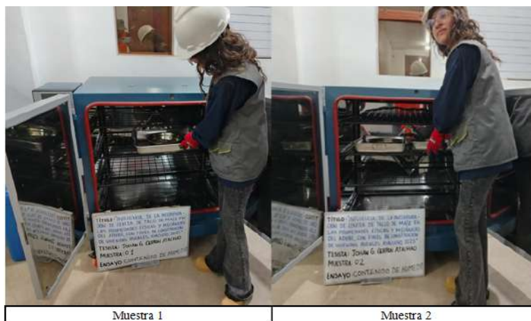
Figura 18 Muestra 1 y 2 de suelo colocadas dentro del horno.
