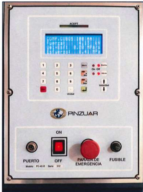
Figura 53: Lectura de la muestra M-1 con 2.5% de ceniza de tallo de maíz
