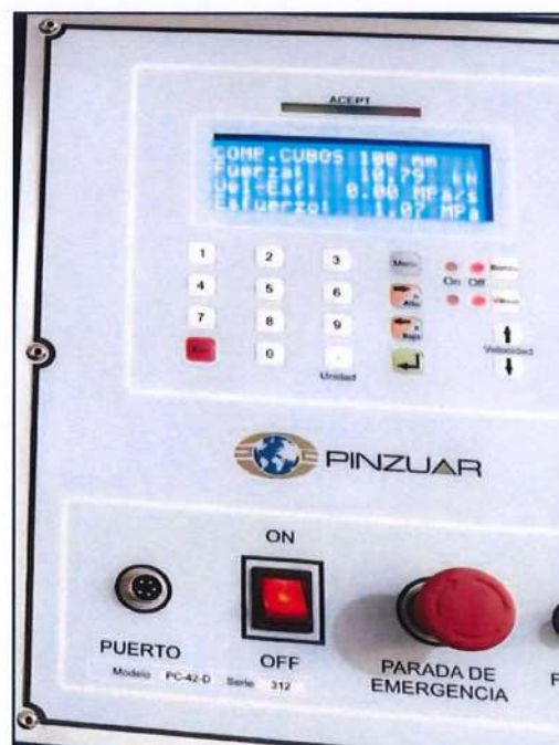
Figura 52: Lectura de la muestra M-6 con 0% de ceniza de tallo de maíz
