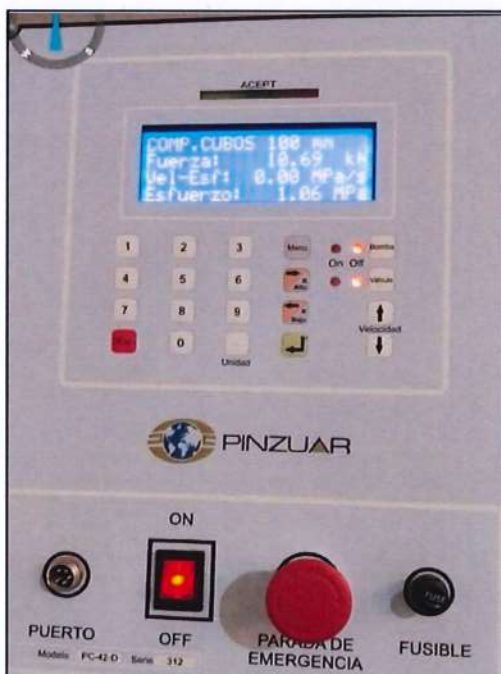
Figura 51: Lectura de la muestra M-4 con 0% de ceniza de tallo de maíz
