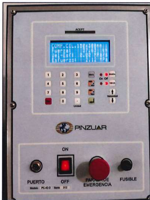
Figura 68: Lectura de la muestra M-2 con 5% de ceniza de tallo de maíz
