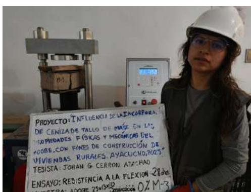
Figura 49 Ensayo de flexión en las instalaciones del laboratorio.
