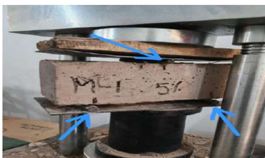
Figura 48 Muestra de adobe sobre los apoyos con separación L.
