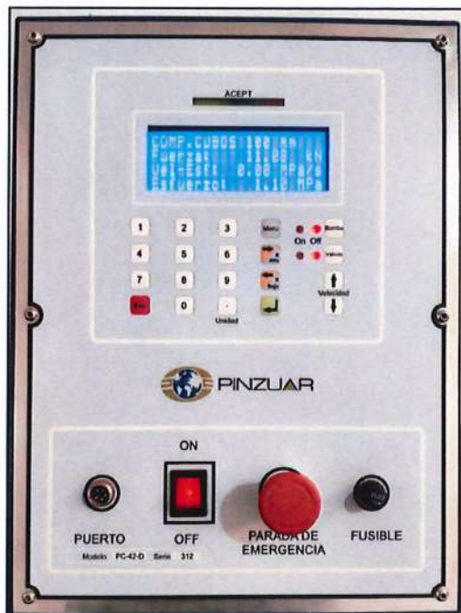
Figura 57: Lectura de la muestra M-2 con 5% de ceniza de tallo de maíz
