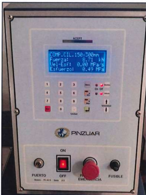
Figura 21: Lectura de la muestra M-1 con 2.5% de ceniza de tallo de maíz
