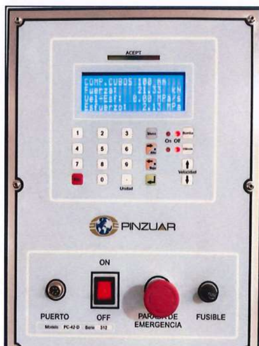
Figura 60: Lectura de la muestra M-2 con 7.5% de ceniza de tallo de maíz
