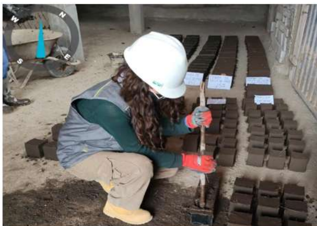
Figura 32 Elaboración de adobes.
