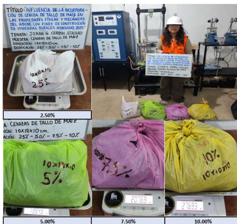
Figura 30 Pesado de la ceniza para la elaboración de adobes de dimensión de 10x10x10cm.
