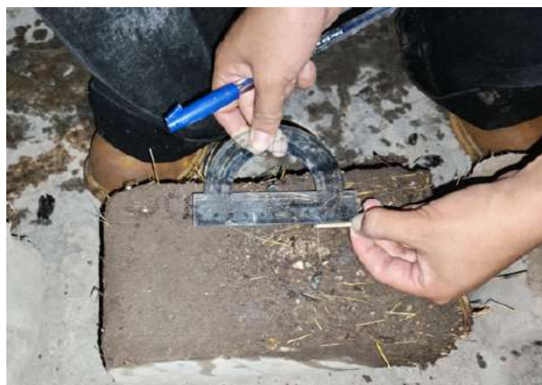
Figura 46 Medida de la muestra 3 del adobe con 5% de ceniza de tallo de maíz.
