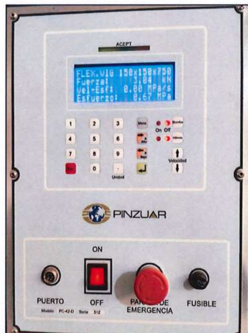
Figura 80: Lectura de la muestra M-5 con 10% de ceniza de tallo de maíz
