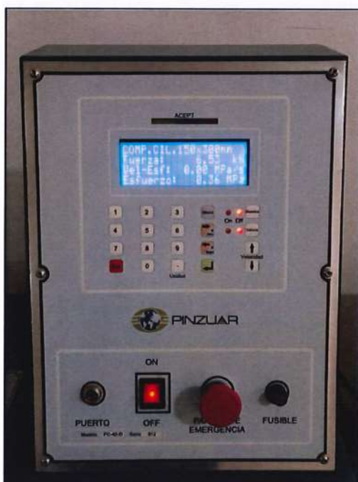
Figura 31: Lectura de la muestra M-1 con 10% de ceniza de tallo de maíz
