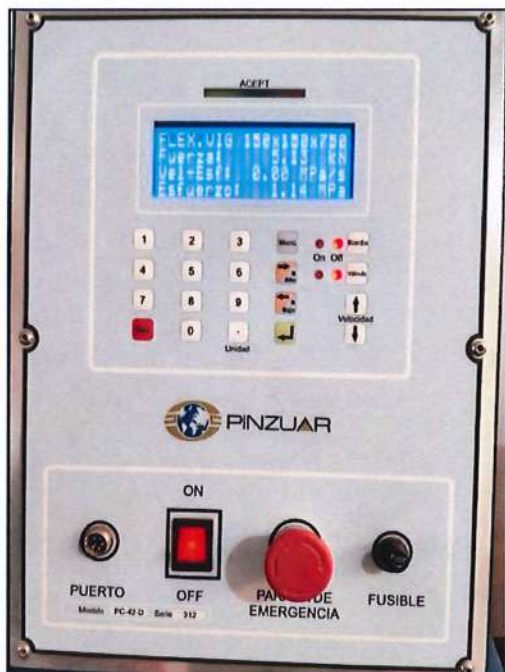
Figura 79: Lectura de la muestra M-6 con 7.5% de ceniza de tallo de maíz
