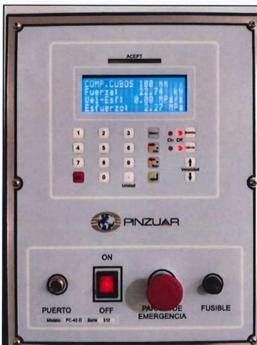
Figura 59: Lectura de la muestra M-1 con 7.5% de ceniza de tallo de maíz
