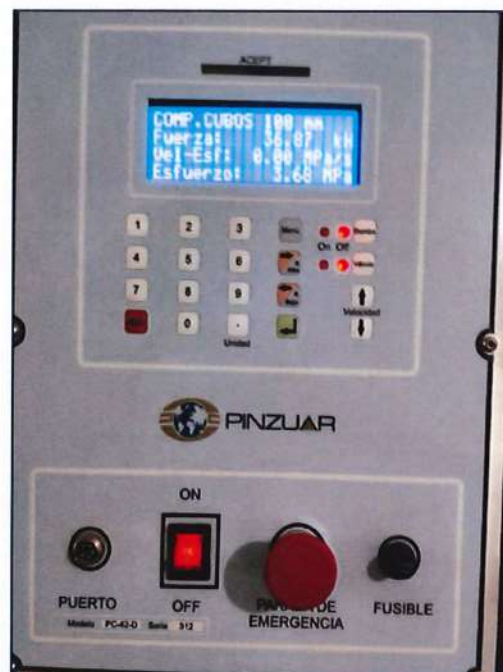
Figura 65: Lectura de la muestra M-4 con 0% de ceniza de tallo de maíz
