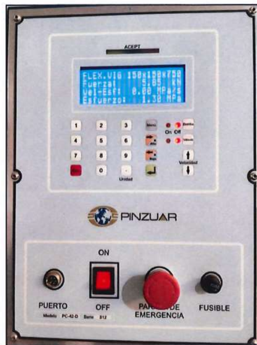
Figura 76: Lectura de la muestra M-4 con 0% de ceniza de tallo de maíz
