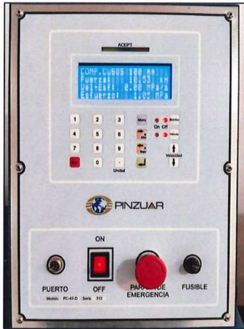
Figura 49: Lectura de la muestra M-2 con 0% de ceniza de tallo de maíz
