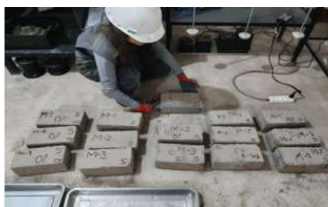
Figura 41 Medición de los adobes.
