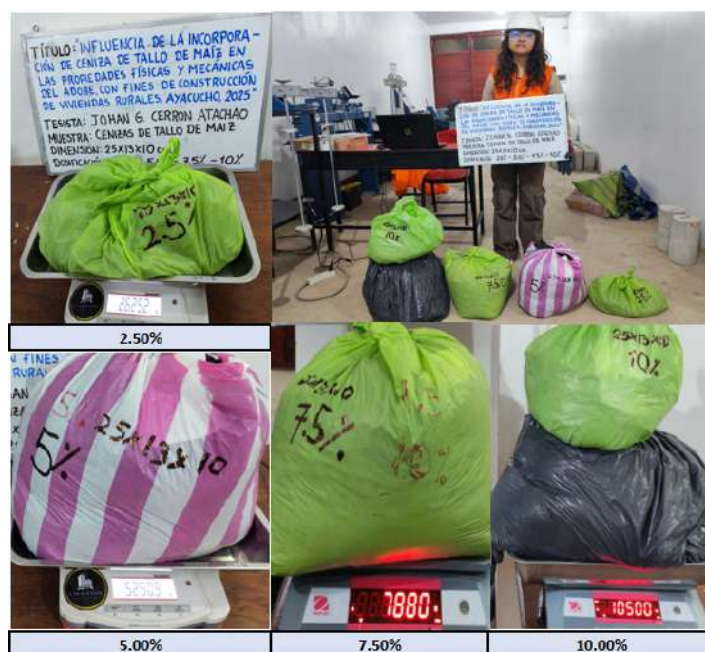
Figura 29 Pesado de la ceniza para la elaboración de adobes de dimensión de 25x13x10cm.
