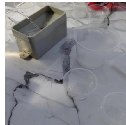
Fotografía 10. Ensayo volumétrico para calibración del pluviómetro tipo balancín.
