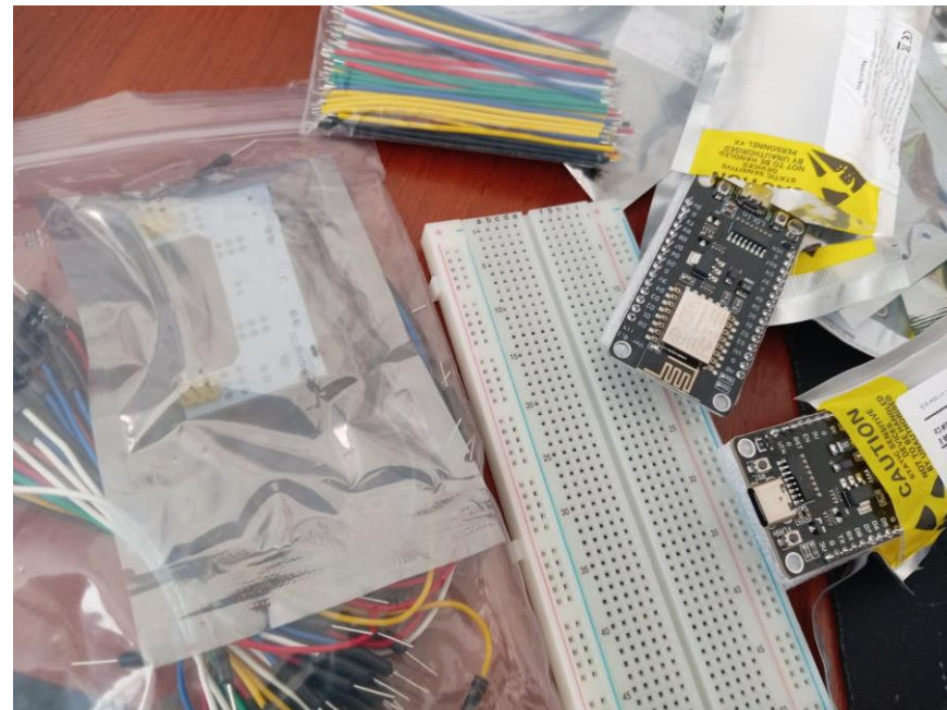
Fotografía 2. Organización de módulos NodeMCU, protoboards y cables de conexión para el prototipado del sistema
