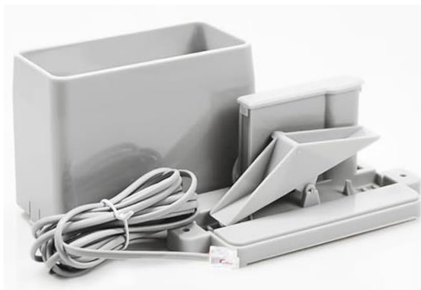
Figura 6. Mecanismo de balancín del pluviómetro tipo tipping bucket
