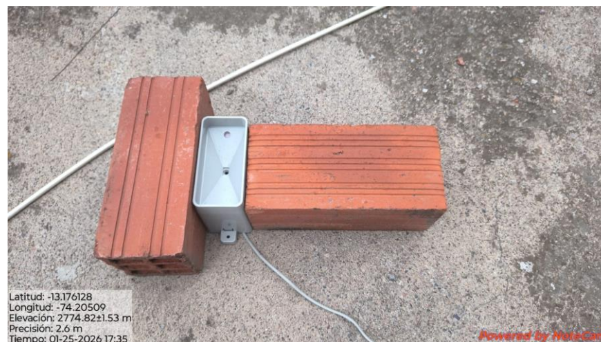
Fotografía 20. Ubicación del pluviómetro en la estación de monitoreo Alder.
