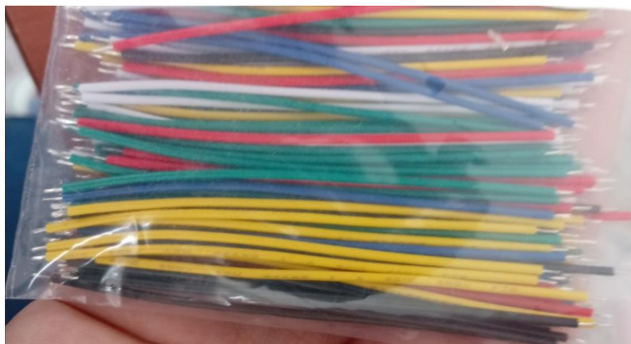
Fotografía 3. Detalle de cables jumper para el acondicionamiento de las conexiones del sistema
