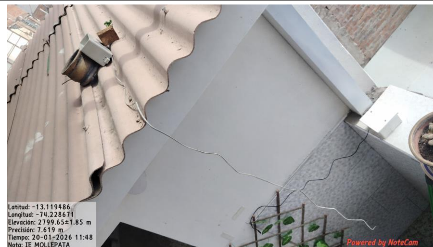
Fotografía 28. Instalación del sensor y módulo de registro en la estación IE Molepata.
