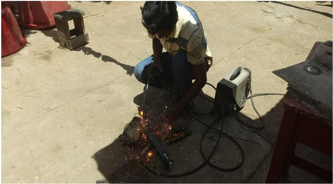
Reparación de barra de tiro.
