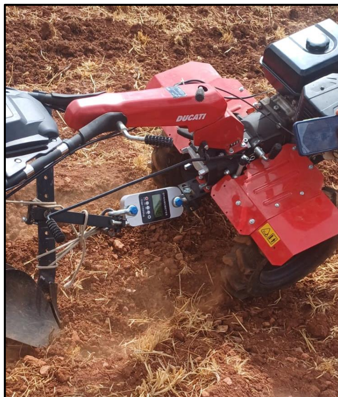
Figura 3. 6. Medición de la fuerza de tiro en el arado de palo y surcador en la motocultivadora
