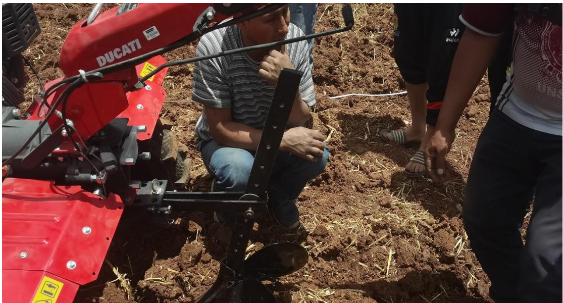
Falla y ruptura de barra de tiro por dureza del terreno.
