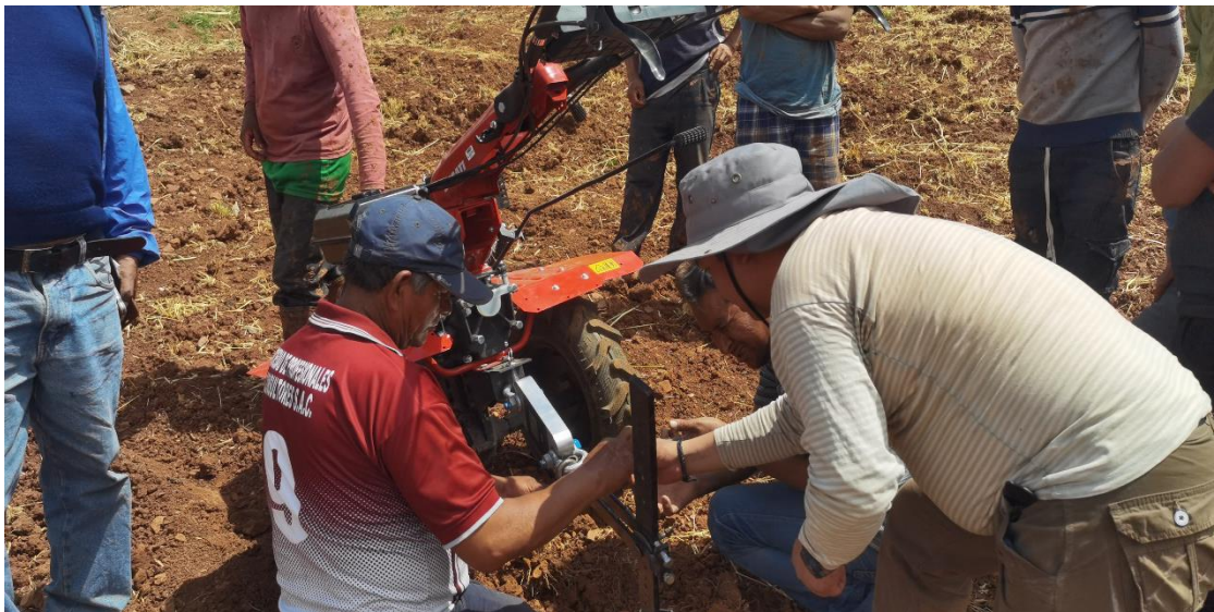
Instalación de dinamómetro para cálculo de potencia.
