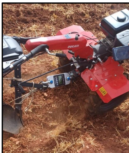
Figura 3. Medición de la fuerza de tiro en el arado de palo y surcador en la motocultivadora
