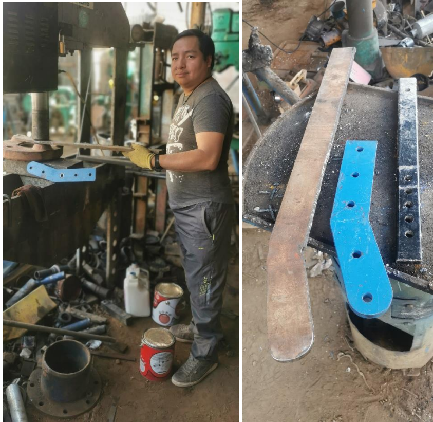
Construcción de barra portaherramientas modificada.
