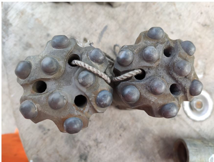
FIGURA N° 4.8: Inadecuado transporte de aceros de perforación.
