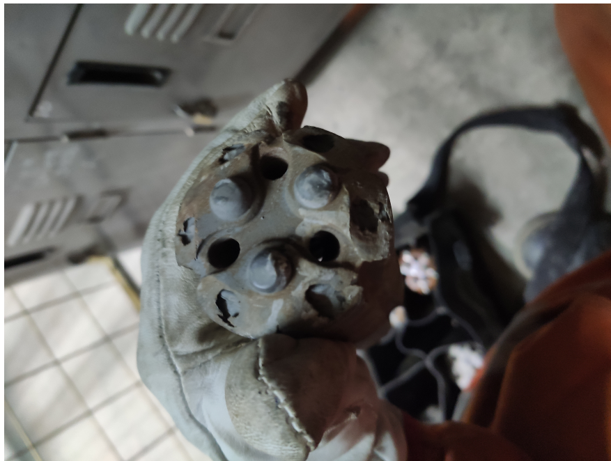
FIGURA N° 4.11: Mala practica de sobreperforación.
