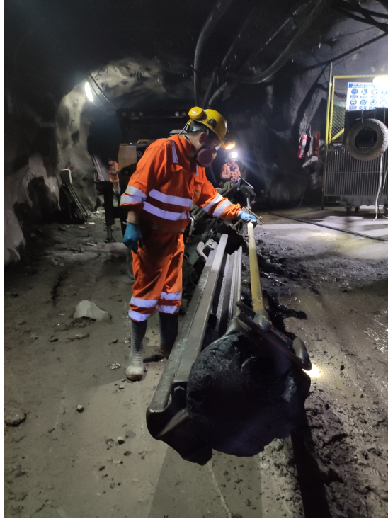
FIGURA N° 4.10: Supervisión en campo de aceros de perforación.
