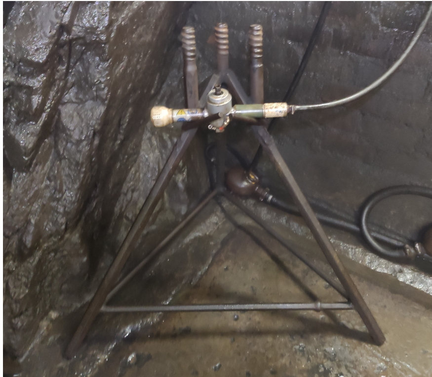
FIGURA N° 2.17: Aguzadora neumática Sandvik RG400
