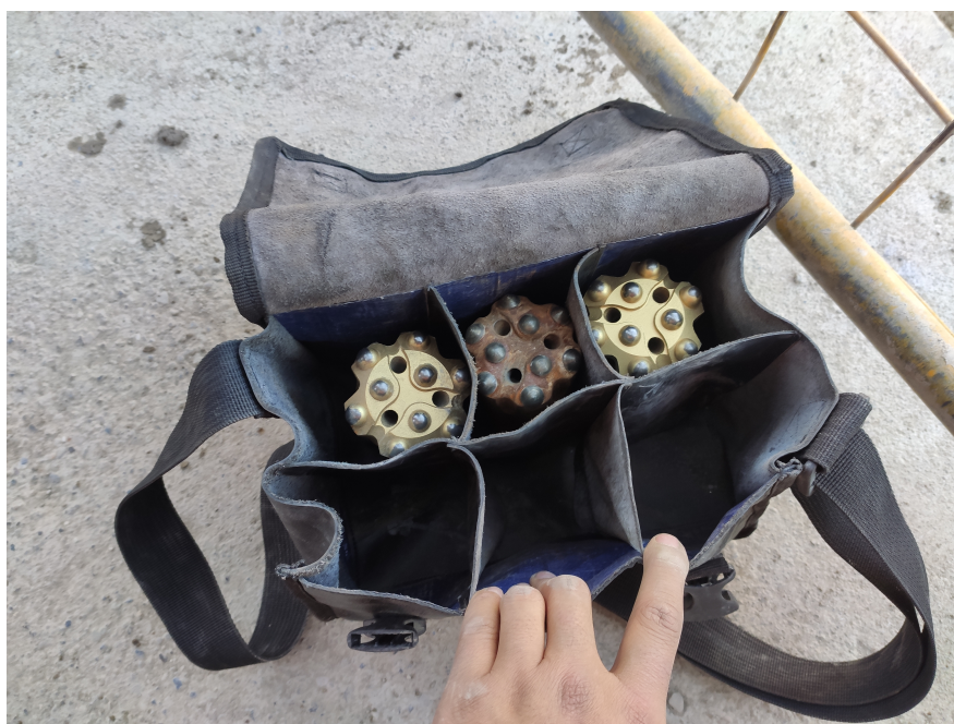
FIGURA N° 4.9: Adecuado transporte de aceros de perforación. Elaboración propia.
