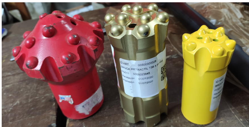
FIGURA N° 2.11: De izquierda a derecha: Rimadora tipo domo; broca retractil de 64mm Y broca de 51mm.
