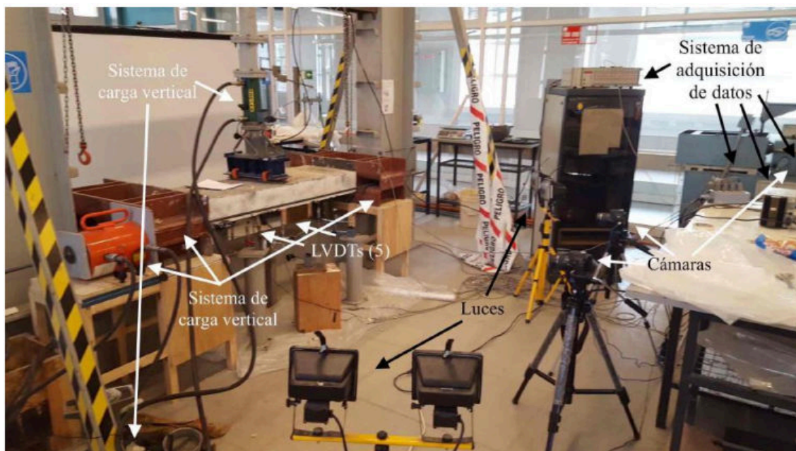
Figura 9 Fotografía esquemática del ensayo de la técnica DIC.
