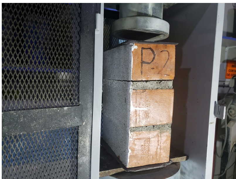
Figura 56 Pila de albañilería P-02. Fuente: Elaboración propia.
