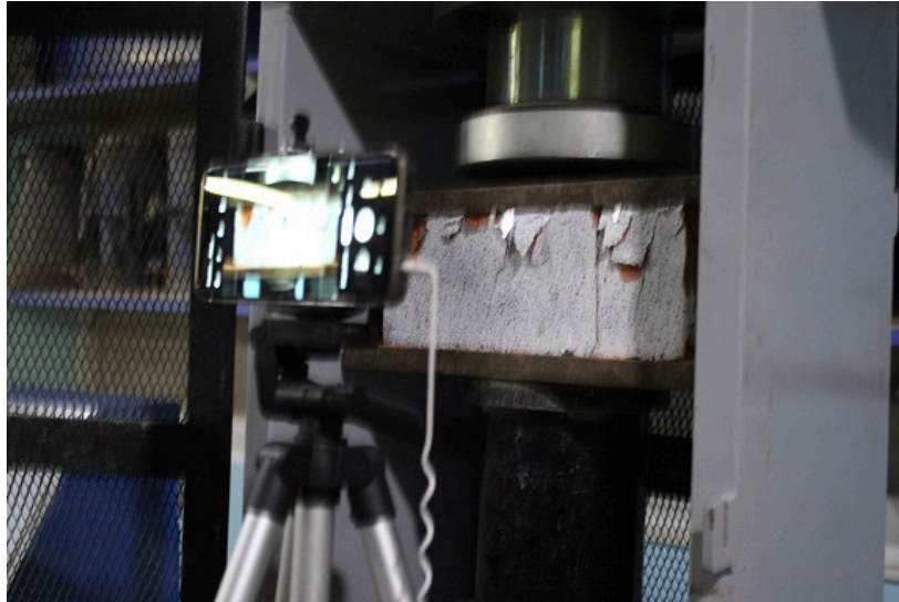
Figura 53 La ubicación de la cámara - ensayo de compresión axial.
