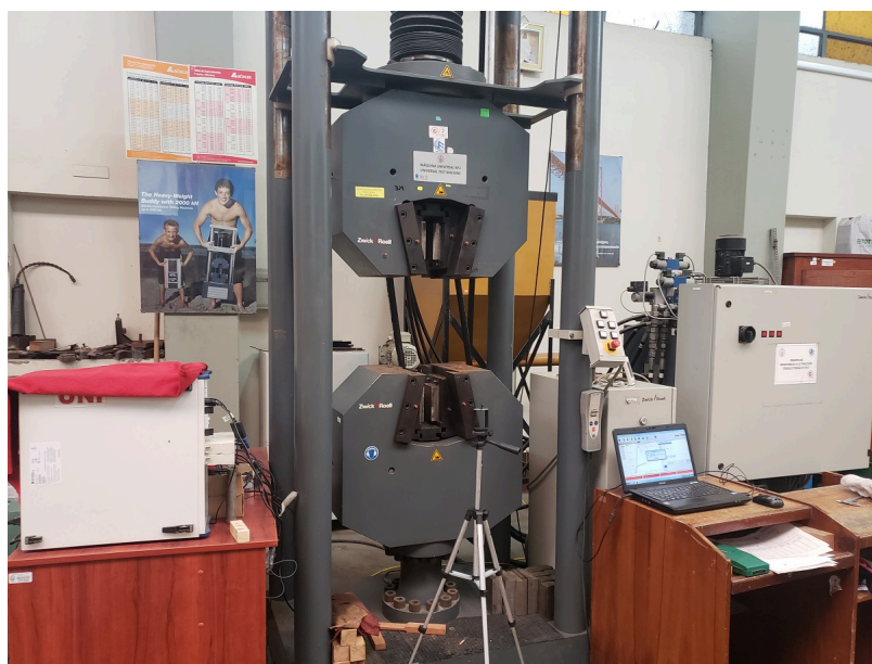
Figura 44 Montaje experimental para el ensayo de tracción - MAQUINA DE ENSAYOS UNIVERSAL: "Zwick/Roell SP1000 - UNI".
