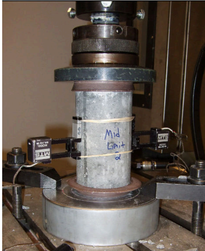
Figura 17 Ensayo de compresión en una probeta cilíndrica.
