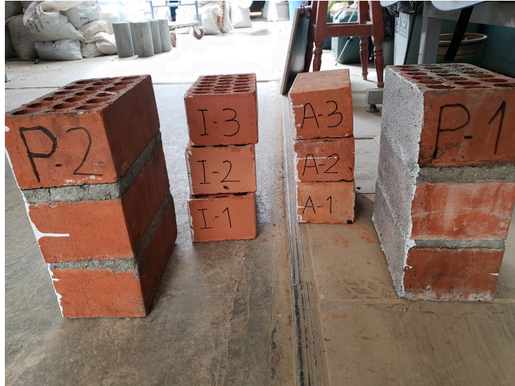
Figura 49 Muestras de albañilería para los ensayos de compresión.
