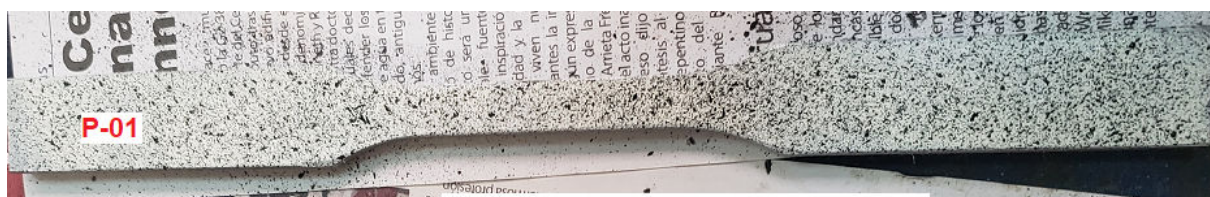
Figura 35 Probeta con el patrón estocástico. Fuente: Elaboración propia.
