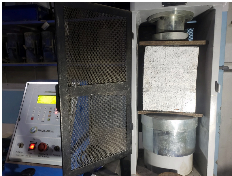
Figura 55 Pila de albañilería para el monitoreo de desplazamientos horizontales y verticales. Fuente: Elaboración propia.
