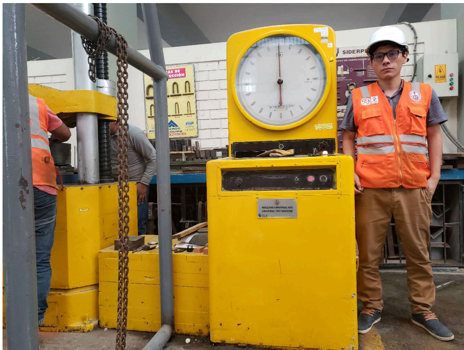
Figura 33 Prensa Hidráulica "Tokyokoki Seizoshō" para los ensayos de compresión. Fuente: Elaboración propia.
