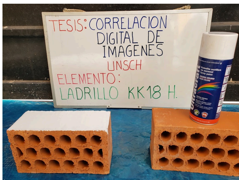
Figura 36 Unidad de ladrillo KingKong Tipo IV con el patrón de moteado.
