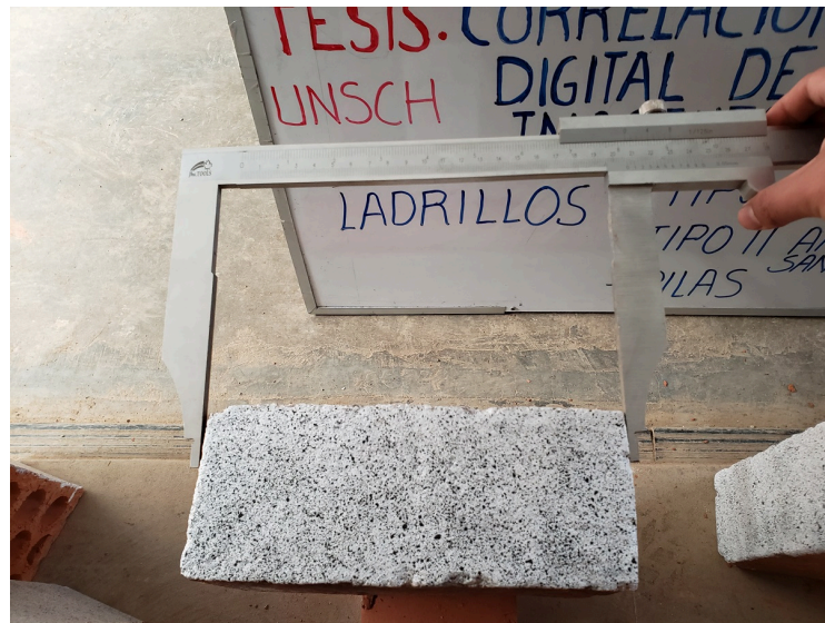
Figura 50 Toma de medidas de las unidades de albañilería.
