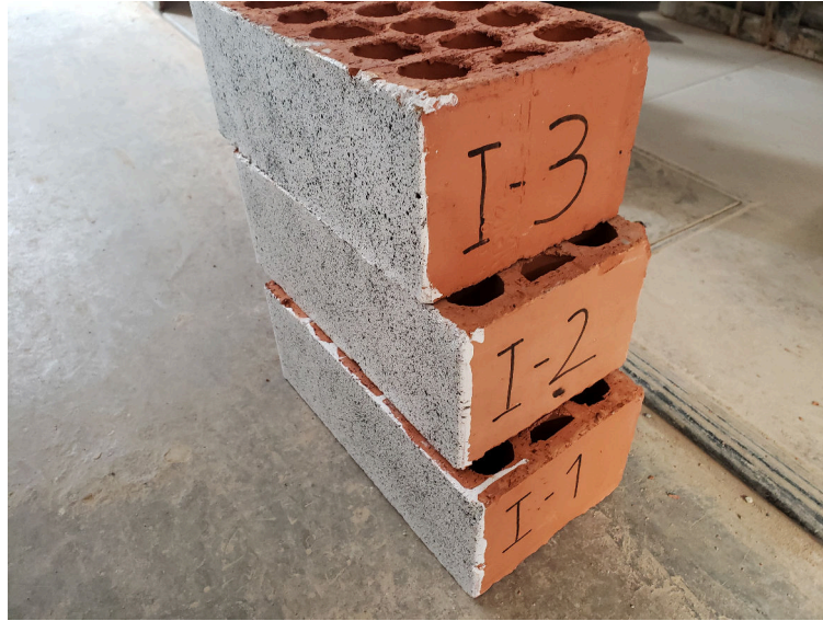
Figura 37 Ladrillos industriales Tipo IV con el patrón de moteado. Fuente: Elaboración propia.
