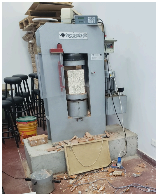
Figura 43 Montaje experimental para el ensayo de compresión - MAQUINA DE ENSAYOS UNIVERSAL: "TECNOTEST MODENA LS200-UNSCH".
