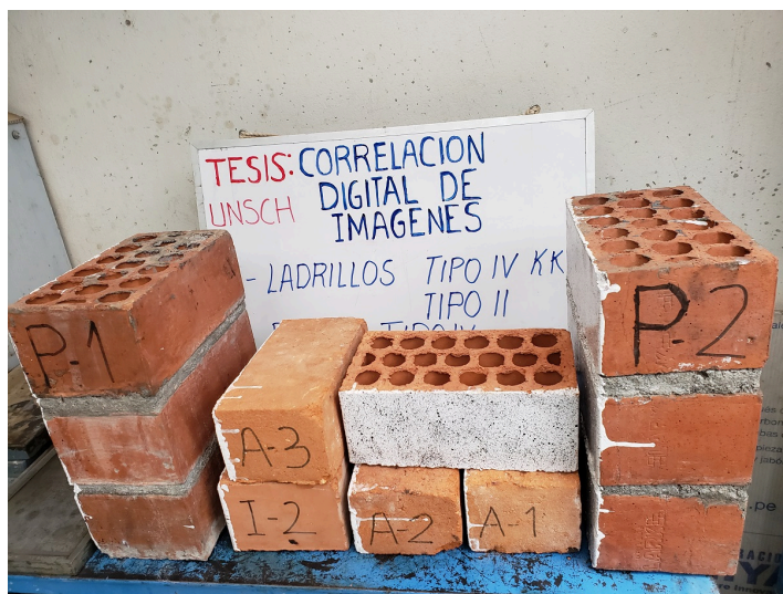
Figura 40 Muestras de albañilería finales para los ensayos de compresión.
