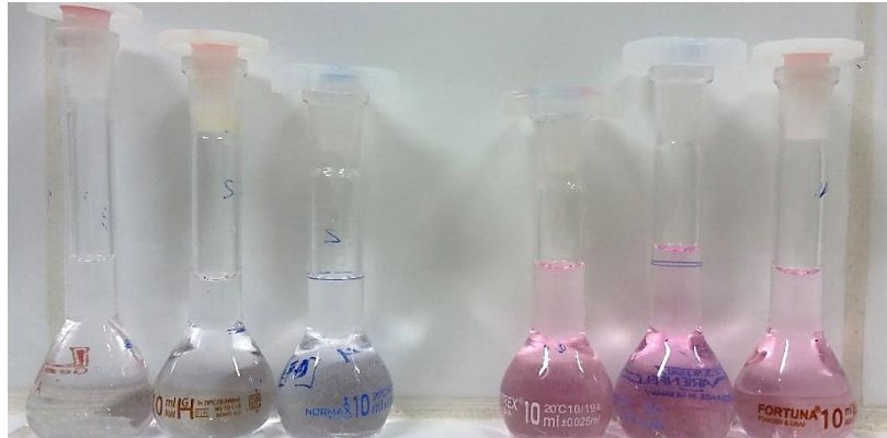
Figura 30: Preparación de la solución de ensayo para las lecturas de antocianinas en el espectofotómetro
