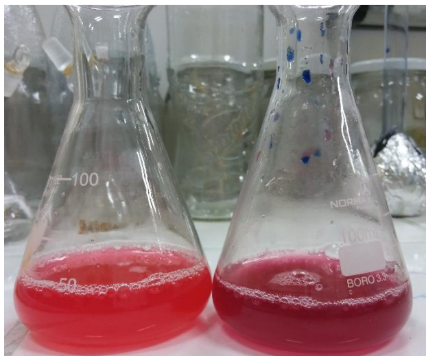
Figura 33: Titulación con 2,6 diclorofenolindofenol
