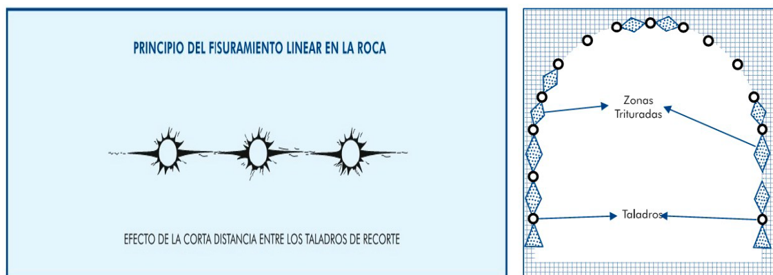
Figura 34. Principio del fisuramiento lineal en la roca
