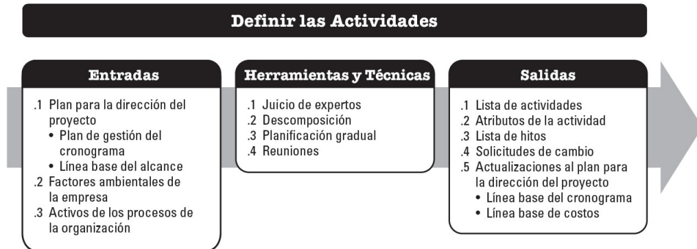
Figura 2.8: Proceso de definición de actividades: entradas, herramientas y técnicas, y salidas (Fuente: PMBOK, 2017)
