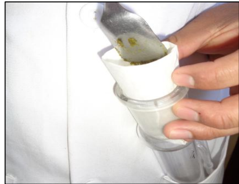
Fotografía 28. Colocación de materia seca en el sifón.
