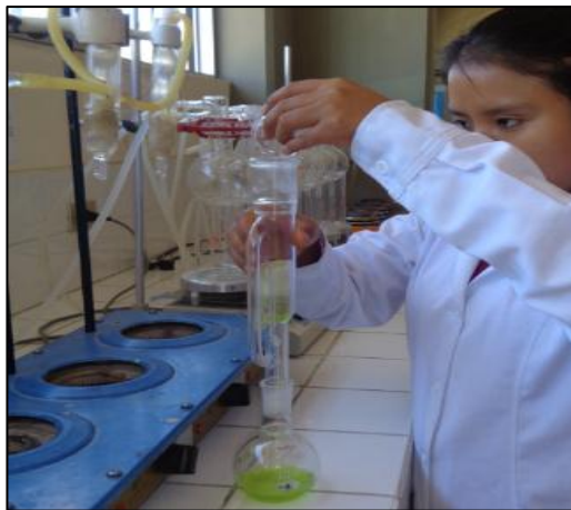
Fotografía 29. Colocación, papel filtro con la muestra en el equipo soxhlet.
