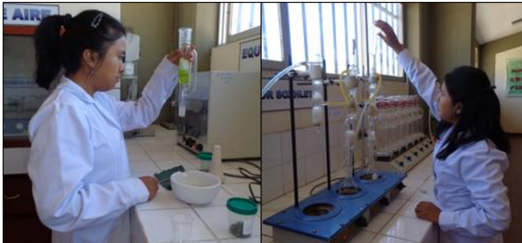
Fotografía 2.7. Realizando el análisis de grasa con el extractor soxhlet.
