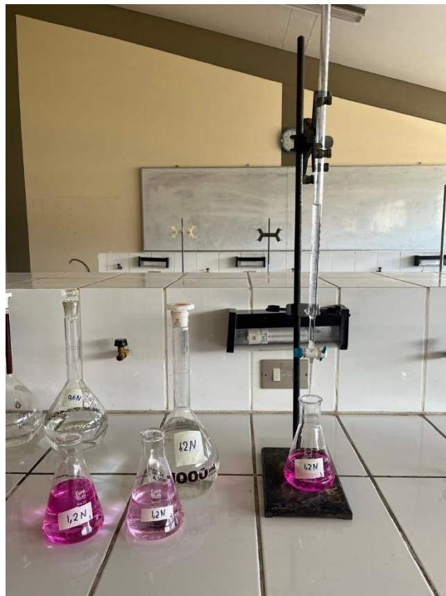
Figura D1: Titulación del ftalato ácido de potasio con hidróxido de sodio 1,2 N
