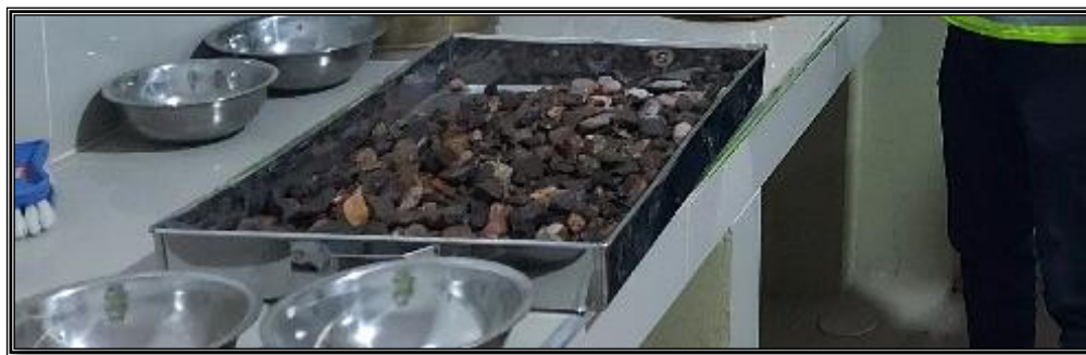
Figura 22: Ensayo de análisis granulométrico del agregado grueso.
