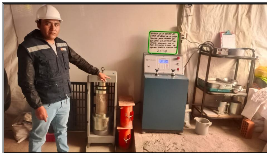
Figura 16: Prensa hidráulica para ensayo de resistencia a la compresión
