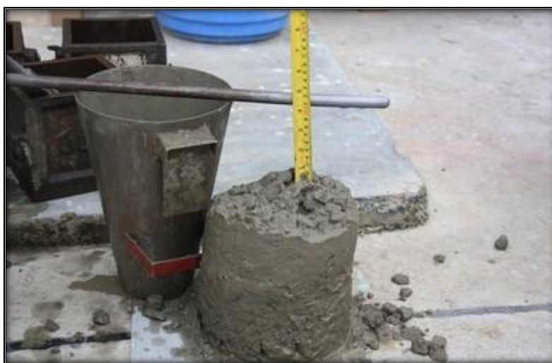
Figura 24 Retirado del cono para determinar el asentamiento.
