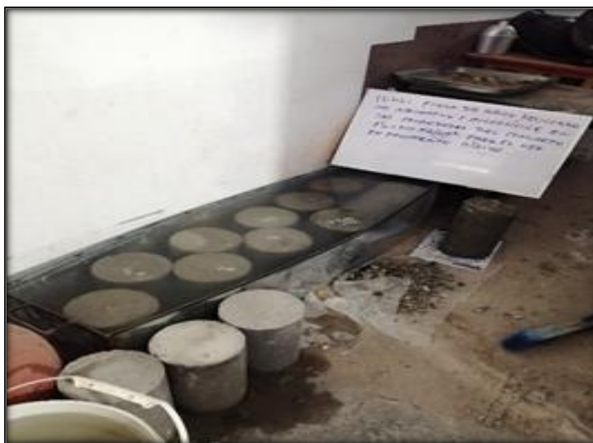
Figura 25 Curado estándar de probetas cilíndricas y vigas
