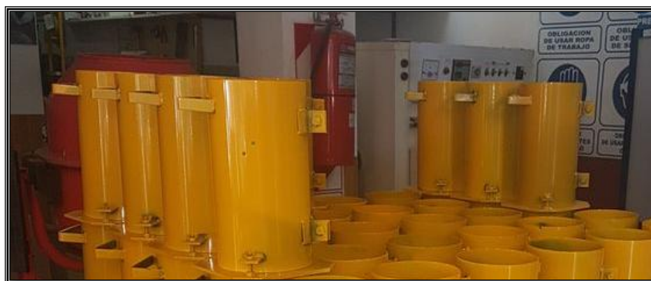
Figura 13: Moldes para probetas de concreto
