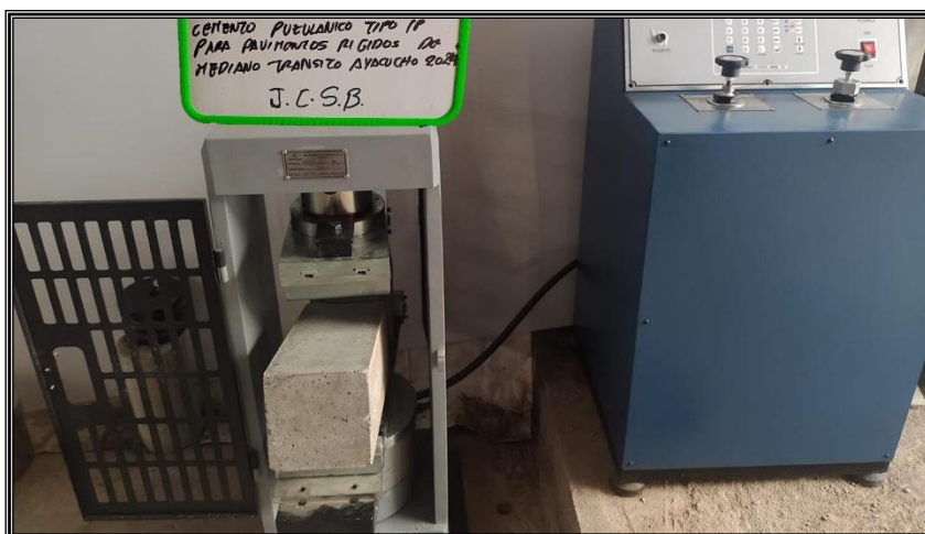
Figura 17: Equipo para ensayo de resistencia a la flexión
