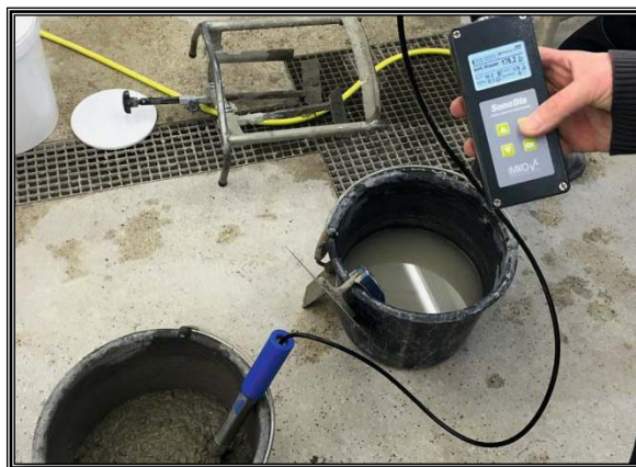
Figura 8: Ensayo de temperatura del concreto en estado fresco.
