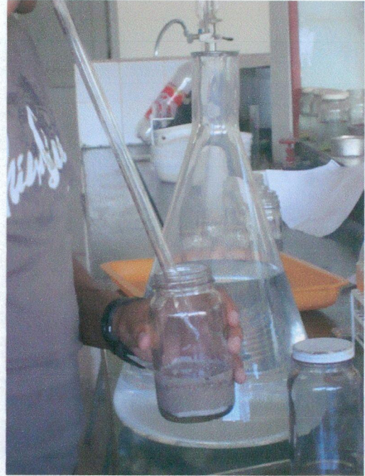
Imágenes 16 y 17. Incorporación de 50ml de agua desionizada a cada uno de los tratamientos
