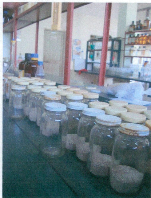
Imágenes 11 y 12. Incorporación de las muestras de los estratos del suelo pesadas (100 g) en los frascos de vidrio
