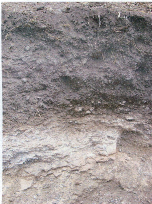
Imágenes 01 y 02. Corte vertical del suelo muestreado, se observan los estratos de donde fueron extraídos las muestras de suelo
