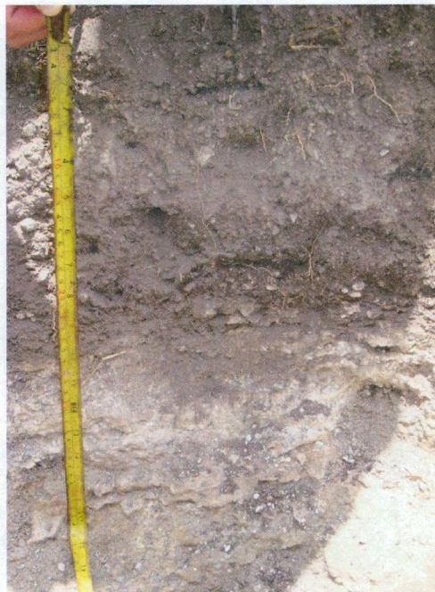
Imágenes 01 y 02. Corte vertical del suelo muestreado, se observan los estratos de donde fueron extraídos las muestras de suelo
