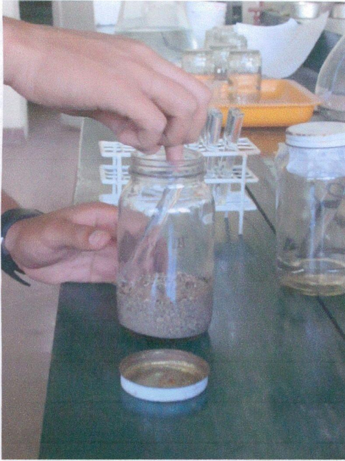
Imagen 19. Incorporación del tubo vial conteniendo 8ml de NaOH
