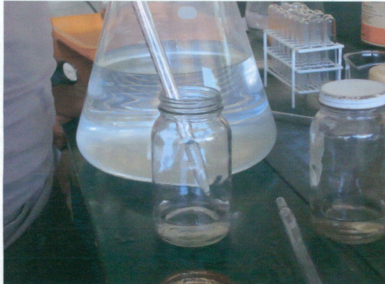
Imagen 18. Preparación de los blancos con 50ml de agua desionizada
