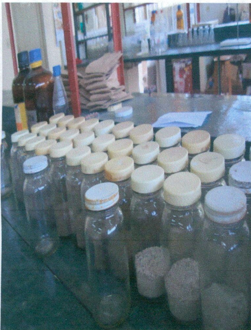
Imágenes 11 y 12. Incorporación de las muestras de los estratos del suelo pesadas (100 g) en los frascos de vidrio
