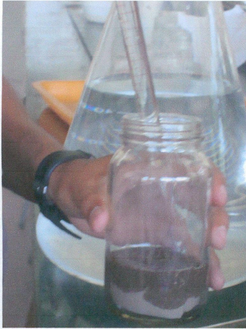
Imágenes 16 y 17. Incorporación de 50ml de agua desionizada a cada uno de los tratamientos
