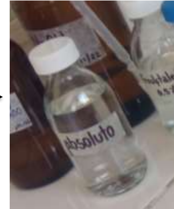
Detener la reacción con 2,5 ml de etanol absoluto.
