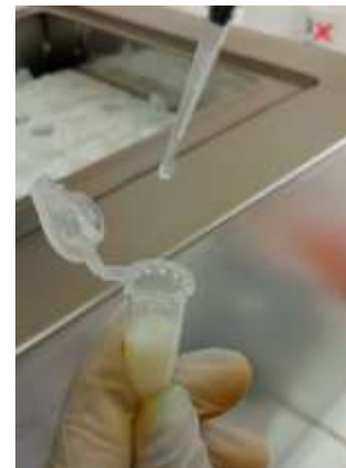
Añadir 10 \mu l del Extracto Enzimático Crudo (EEC)
