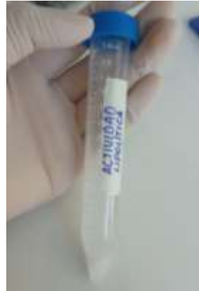
Mezclar 5 ml de sustrato emulsionado con 250 \mu l de EEC diluido 1:3
