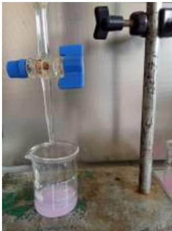
Anotar el volumen gastado de NaOH 0,01 M
