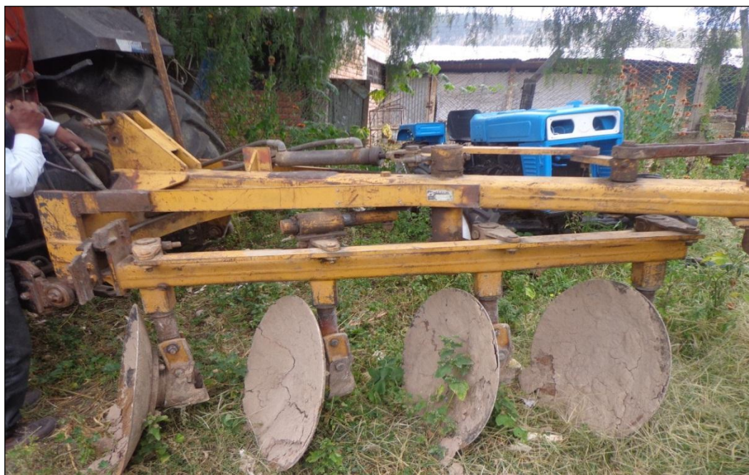
Foto 15: Arado reversible de cuatro discos utilizado en Pampa del arco. Ayacucho 2750 msnm
