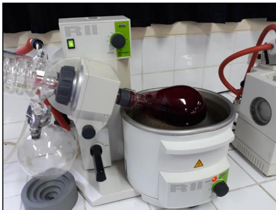
Figura 3.8: Concentración de jugo de arándano con el Rotavapor
