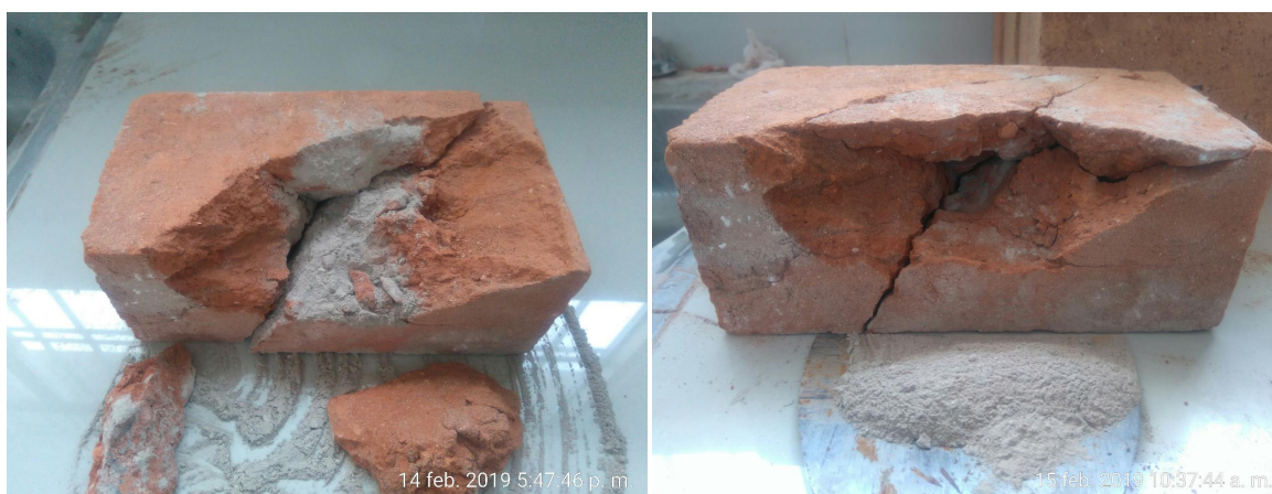
Figura 64 Efectos de la desintegración de la caliza en la unidad artesanal.
