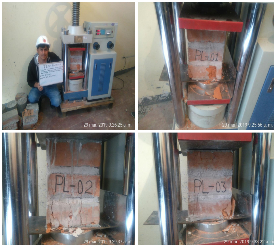
Figura 49 Rotura de las pilas de albañilería.
