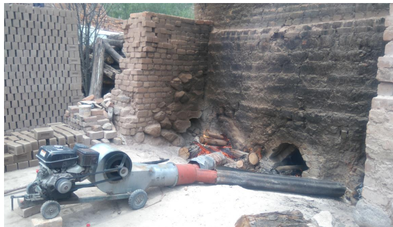
Figura 35 Equipo de bomba para acelerar encendido del fuego en el horno para la fábrica de ladrillo artesanal. Fuente: Elaboración propia
