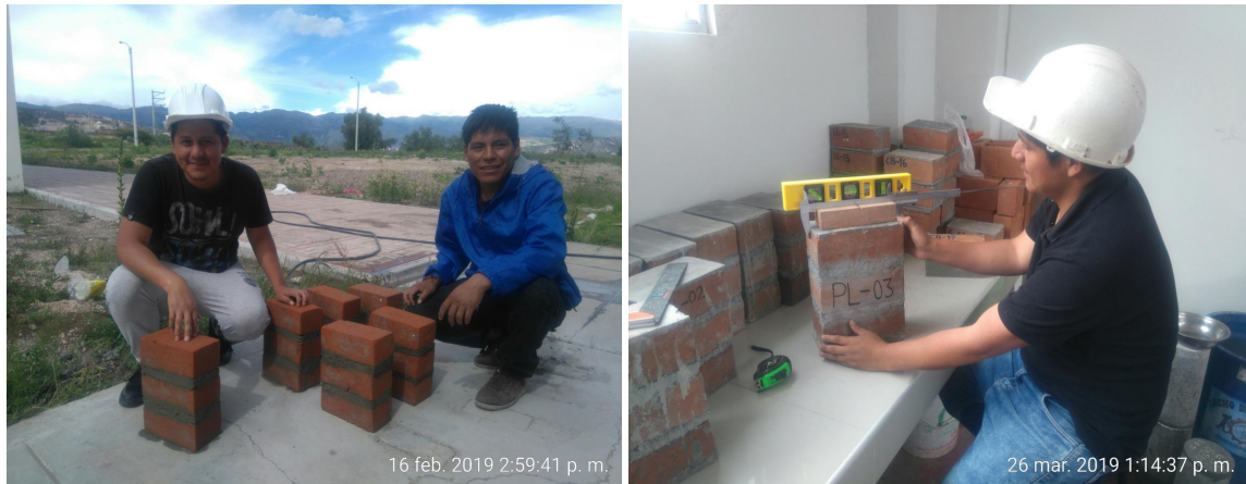
Figura 47 Pilas de albañilería.
