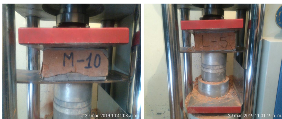
Figura 46 Rotura de la unidad artesanal. Fuente: Elaboración propia
