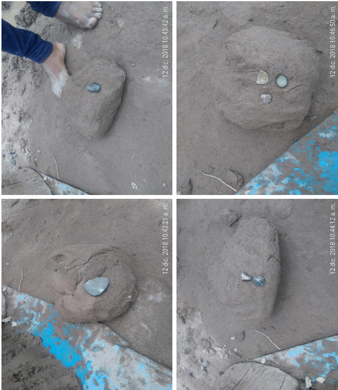
Figura 39 Inclusión de partículas de roca de tamaño máximo de 1" a 2" en la masa. Fuente: Elaboración propia
