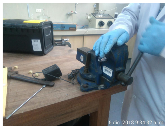
Figura 20 Trituración de las partículas de roca, muestra. Fuente: Elaboración propia
