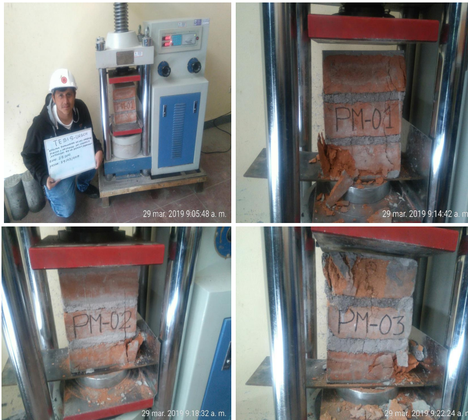
Figura 50 Rotura de las pilas de albañilería.
