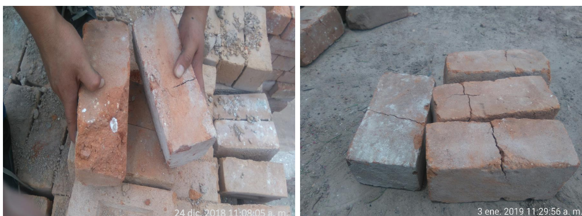
Figura 66 Defectos originados por la inclusión de roca en las unidades artesanales.
