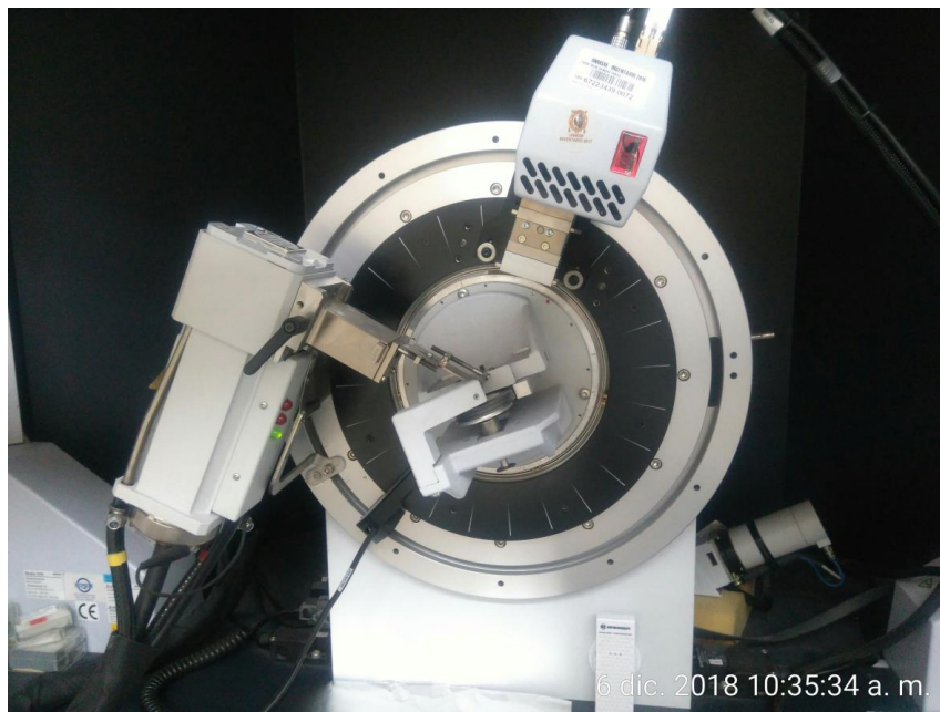
Figura 18 Difractómetro de rayos X, Bruker D8-Focus. Facultad de Ciencias Físicas-UNMSM. Fuente: Elaboración propia
