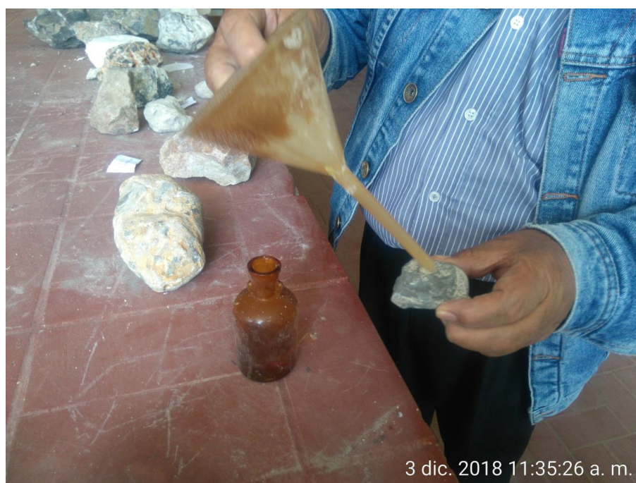
Figura 15 Ácido clorhídrico (HCl) en la caliza.
