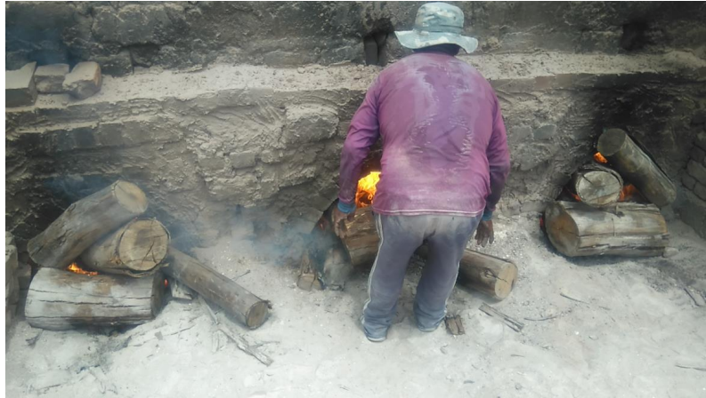
Figura 34 Uso de la leña en la cocción para la fábrica de ladrillo artesanal. Fuente: Elaboración propia
