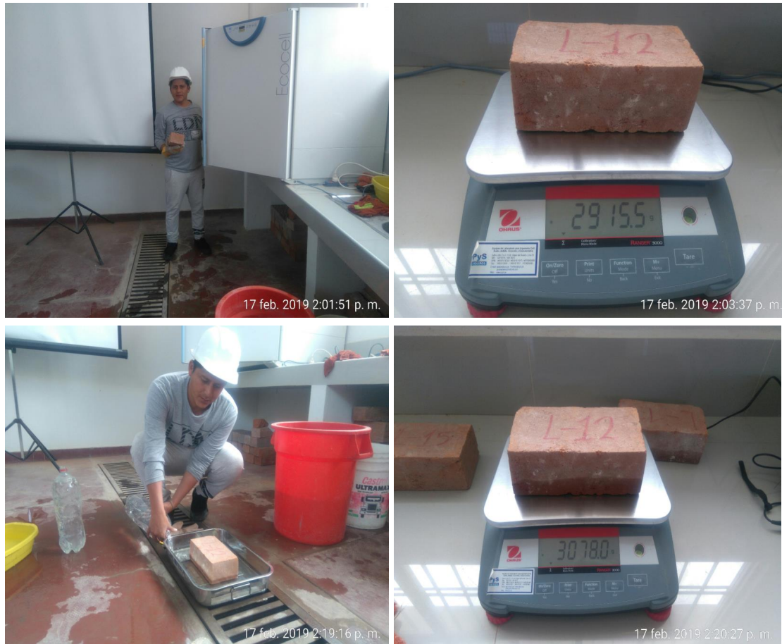
Figura 51 Ensayo succión de la unidad.
