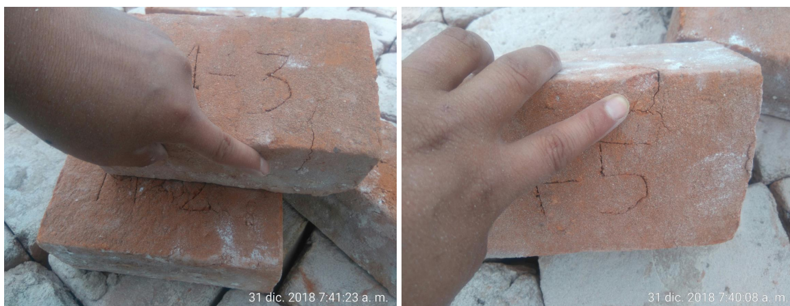
Figura 65 Efectos originadas por la inclusión de roca, con tamaño máximo de 2", en las unidades artesanales .
