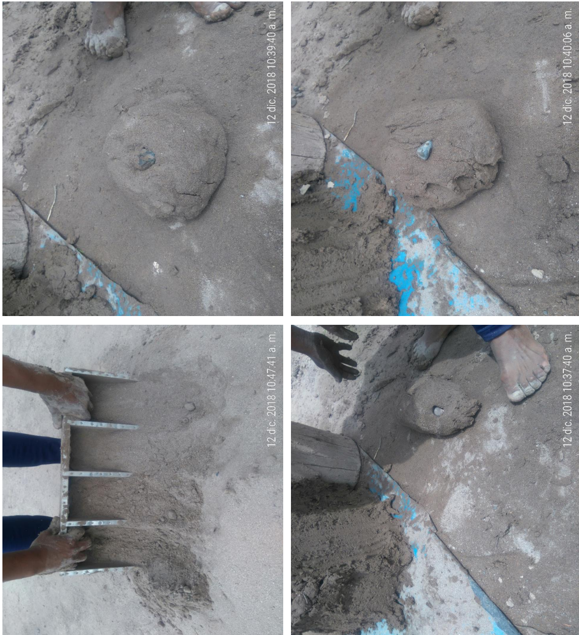
Figura 38 Inclusión de partículas de roca de tamaño máximo de 1" a 2" en la masa. Fuente: Elaboración propia
