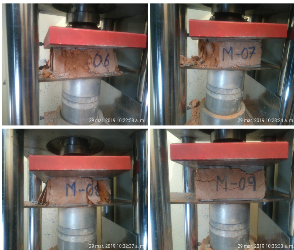
Figura 45 Rotura de la unidad artesanal. Fuente: Elaboración propia
