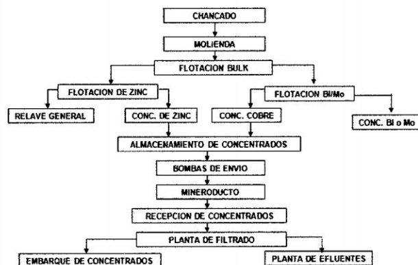
Figura 3.7: Secuencia del tratamiento de mineral
