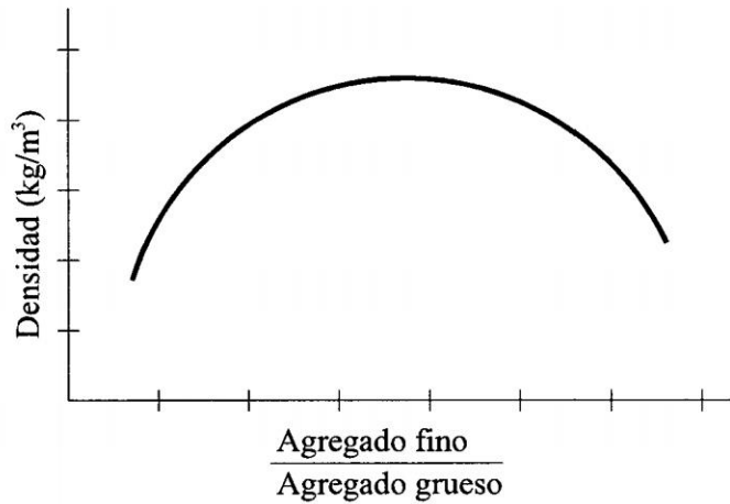
Figura 3.2: Curva típica del ensayo de compactación, para diferentes relaciones entre agregados
